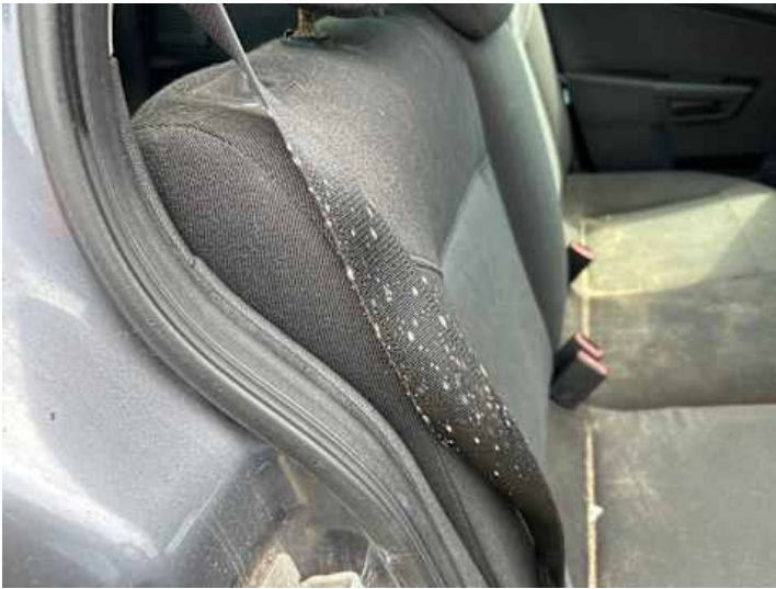
Innenraum (Diverse Schäden, Anderer Schaden): Schimmel;
