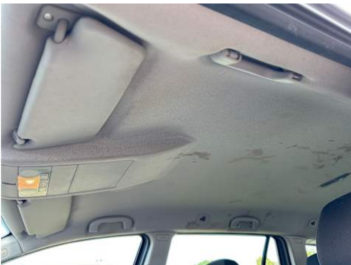
Innenraum (Diverse Schäden, Anderer Schaden): Schimmel;
