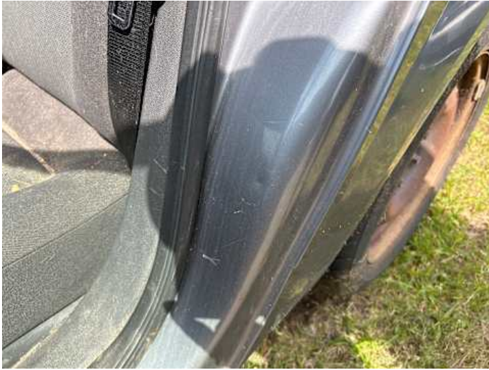
Türe hinten links (Kratzer, Delle, Rost)
