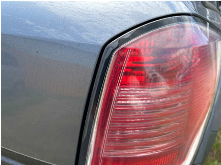
Rücklicht (rechts) (Riss/Bruch)
