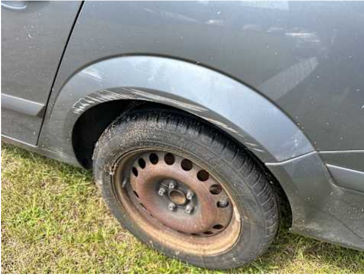
Seitenteil hinten links (Delle, Kratzer, Lackschaden)
