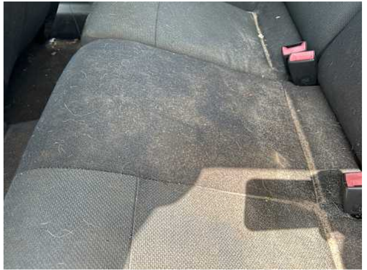
Innenraum (Diverse Schäden, Anderer Schaden): Schimmel;
