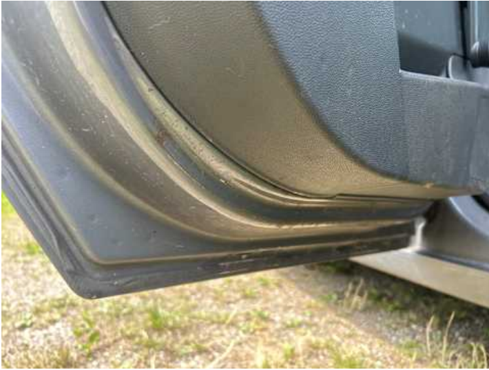
Türe hinten links (Kratzer, Delle, Rost)
