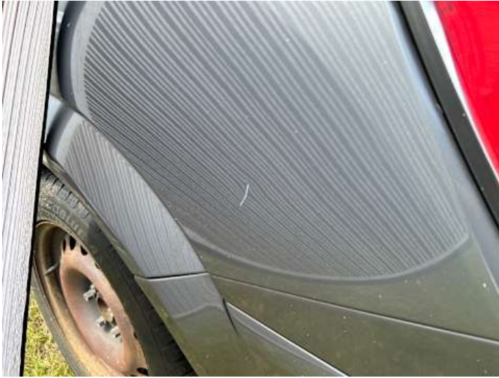
Seitenteil hinten links (Delle, Kratzer, Lackschaden)
