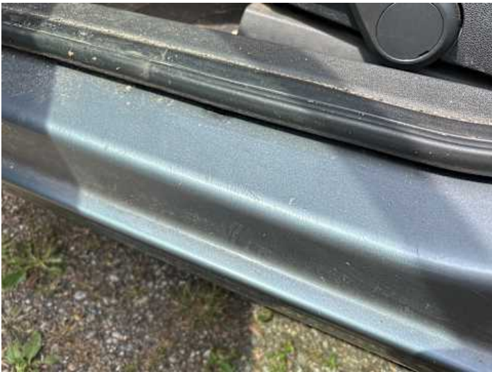
Schweller links (Kratzer, Verformung)
