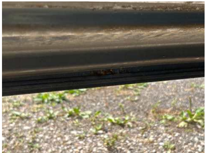
Fahrtür (Kratzer, Rost)
