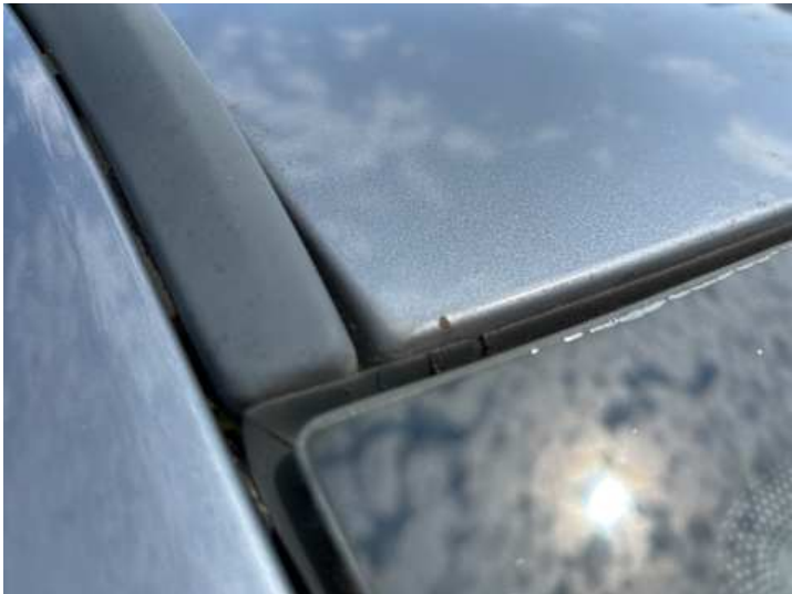
Dach (Steinschlag, Delle)
