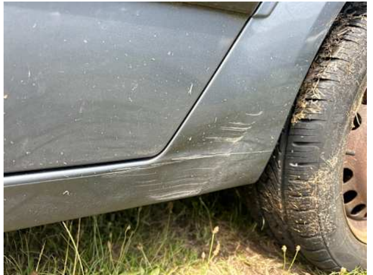
Schweller links (Kratzer, Verformung)
