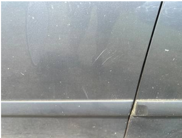
Fahrtür (Kratzer, Rost)
