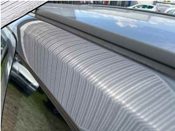
Dach (Steinschlag, Delle)
