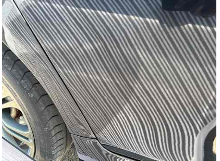
Türe hinten rechts (Unsachgemäß instand gesetzt)
