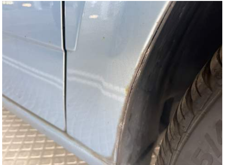
Kotflügel vorne rechts (Rost)
