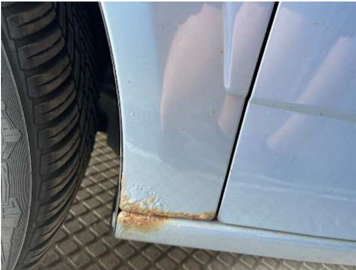
Kotflügel vorne links (Rost)
