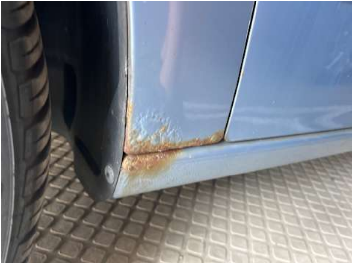
Schweller links (Rost)
