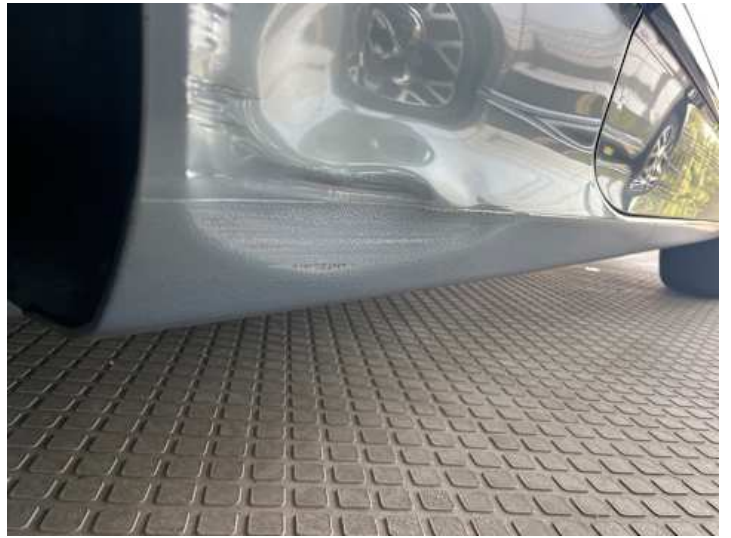
Schweller rechts (Lackschaden, Kratzer, Verformung)
