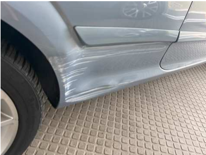
Seitenteil hinten rechts (Lackschaden, Kratzer, Verformung)
