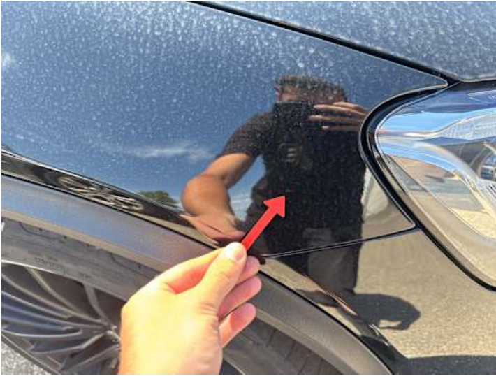
Kotflügel vorne rechts (Steinschlag, Unsachgemäß instand gesetzt)
