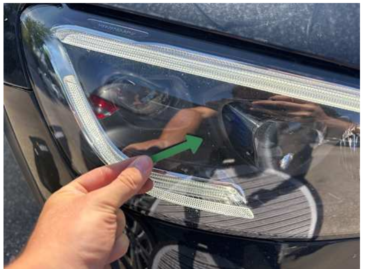
Scheinwerfer (rechts) (Steinschlag)
