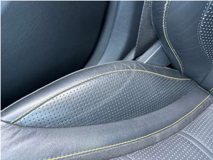
Innenraum (Kratzer, Verschleiß)
