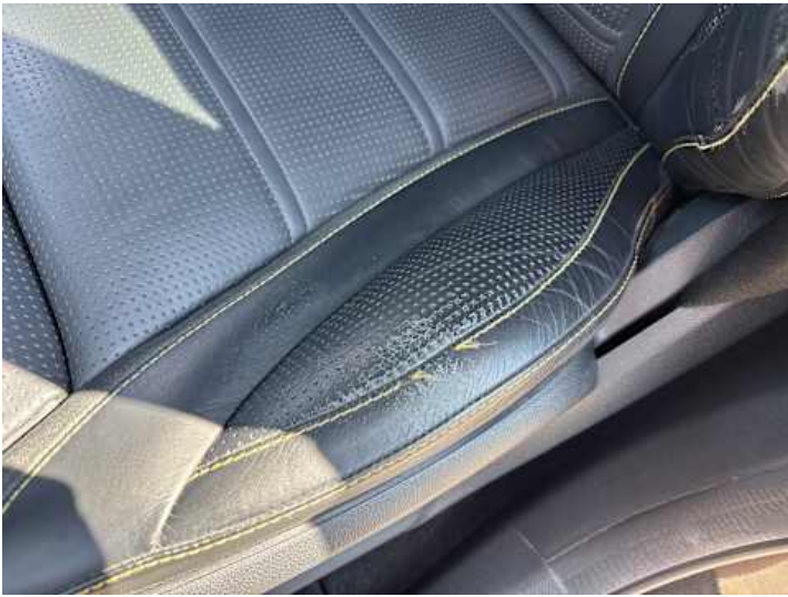
Innenraum (Verschleiß, Riss/Bruch, Kratzer)
