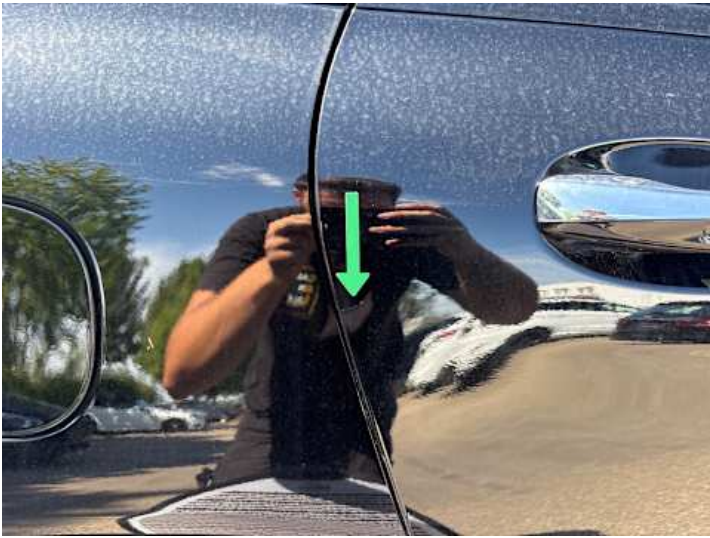
Türe hinten rechts (Kratzer, Lackschaden)
