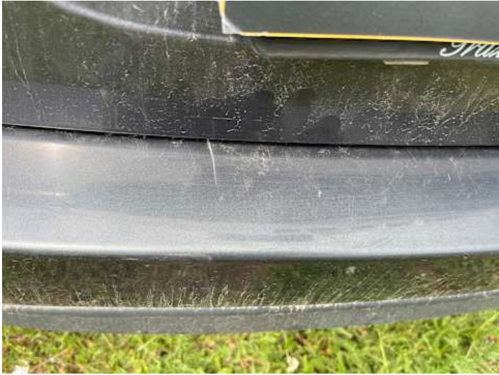
Stoßstange hinten (Kratzer, Lackschaden)
