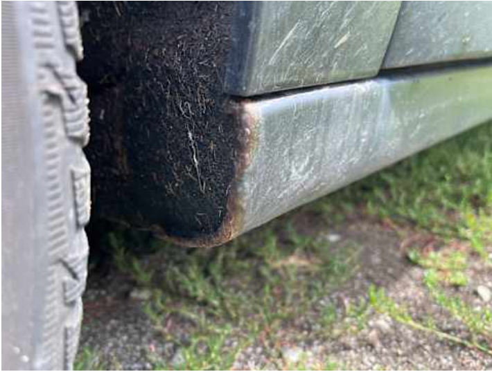
Schweller links (Rost)
