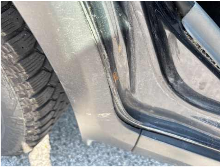
Schweller rechts (Rost)
