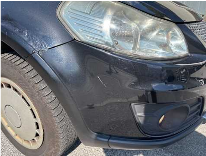
Stoßstange vorne (Unsachgemäß instand gesetzt, Ausgeblichen/Matt)
