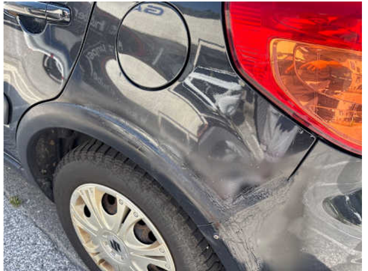
Seitenteil hinten links (Unsachgemäß instand gesetzt, Lackschaden)
