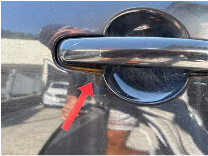
Türe hinten links (Rost)
