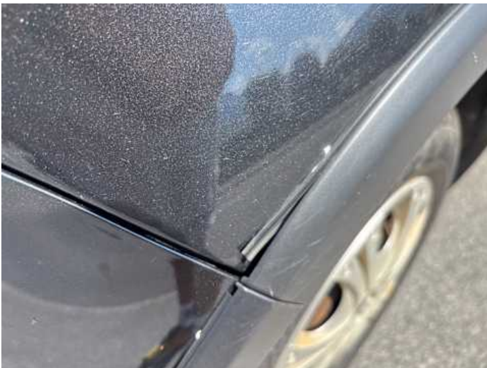
Seitenteil hinten rechts (Kratzer, Spaltmaße ungenau)
