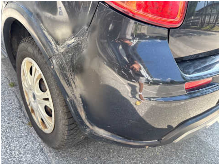
Stoßstange hinten (Unsachgemäß instand gesetzt, Lackschaden)
