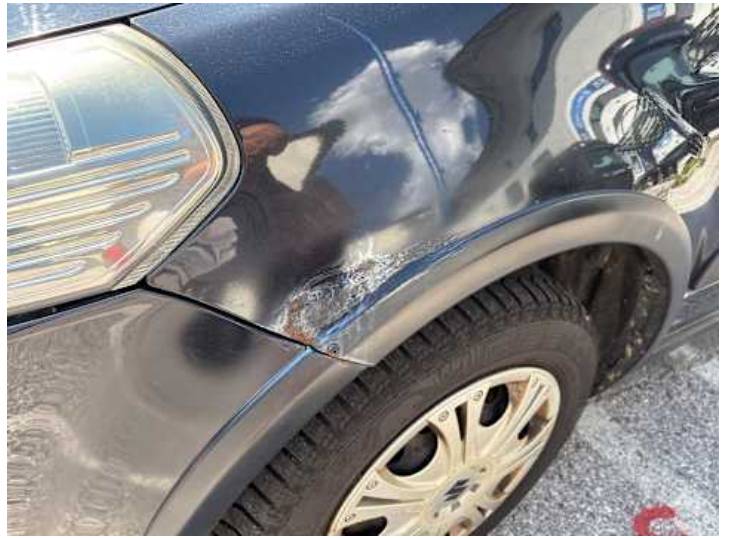
Kotflügel vorne links (Rost, Unsachgemäß instand gesetzt)
