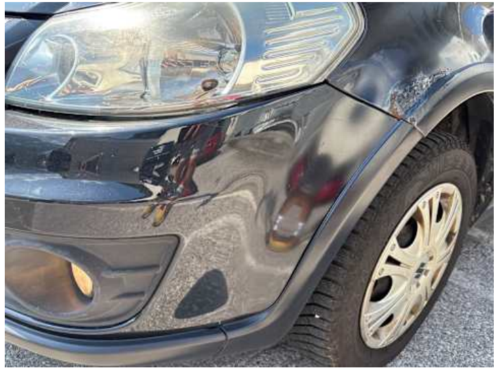
Stoßstange vorne (Unsachgemäß instand gesetzt, Ausgeblichen/Matt)
