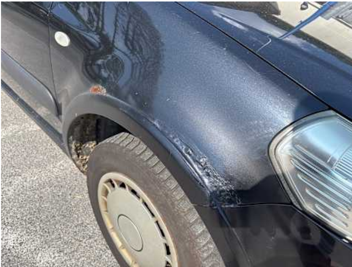
Kotflügel vorne rechts (Rost, Unsachgemäß instand gesetzt)
