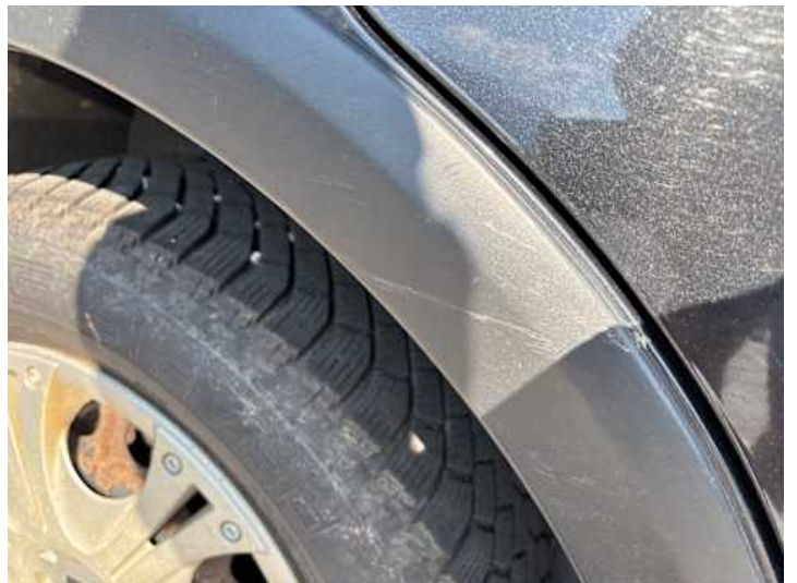
Seitenteil hinten rechts (Kratzer, Spaltmaße ungenau)
