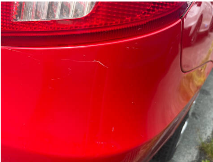
Stoßstange hinten (Lackschaden, Kratzer)
