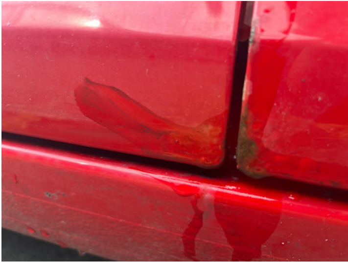
Türe hinten rechts (Rost)
