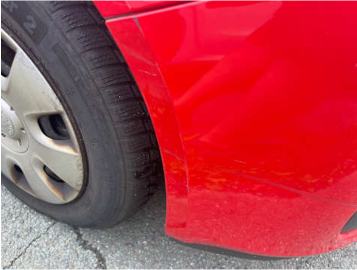
Stoßstange vorne (Lackschaden, Kratzer)
