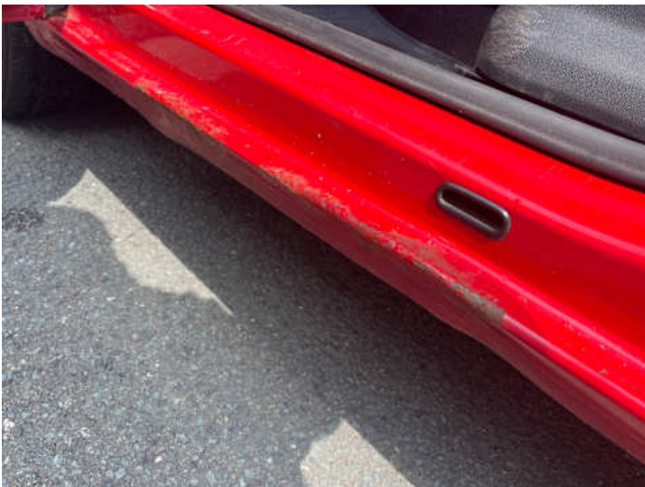
Schweller links (Rost)
