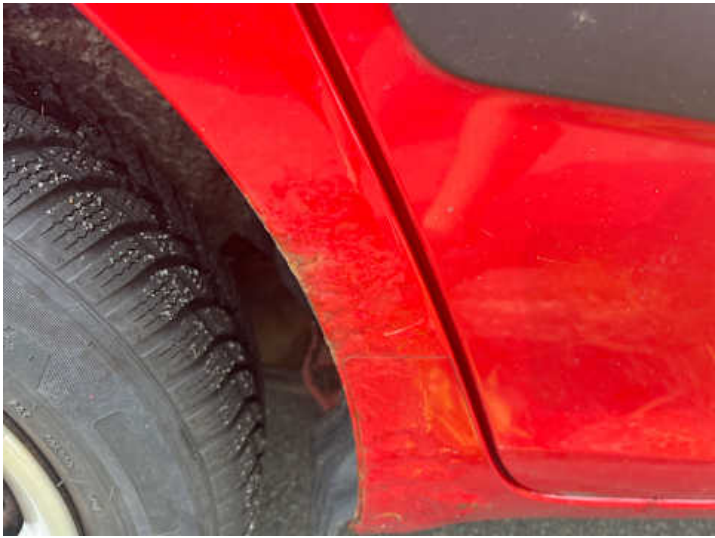
Seitenteil hinten rechts (Rost)
