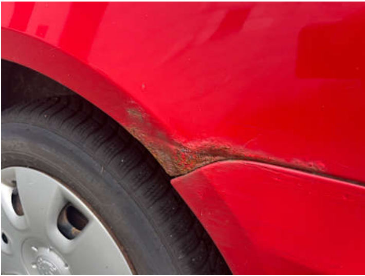
Seitenteil hinten links (Rost, Verformung)
