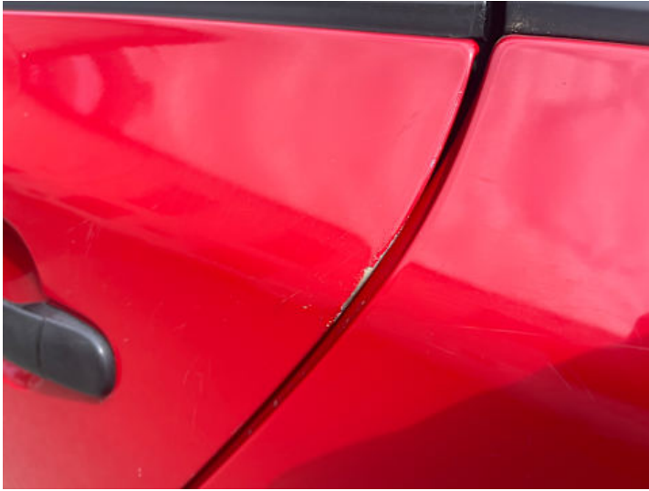
Türe hinten links (Lackschaden)
