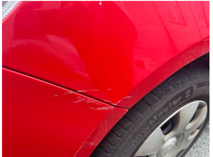
Kotflügel vorne links (Lackschaden, Kratzer)
