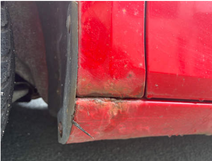
Kotflügel vorne links (Rost)
