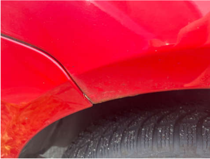
Seitenteil hinten rechts (Rost)
