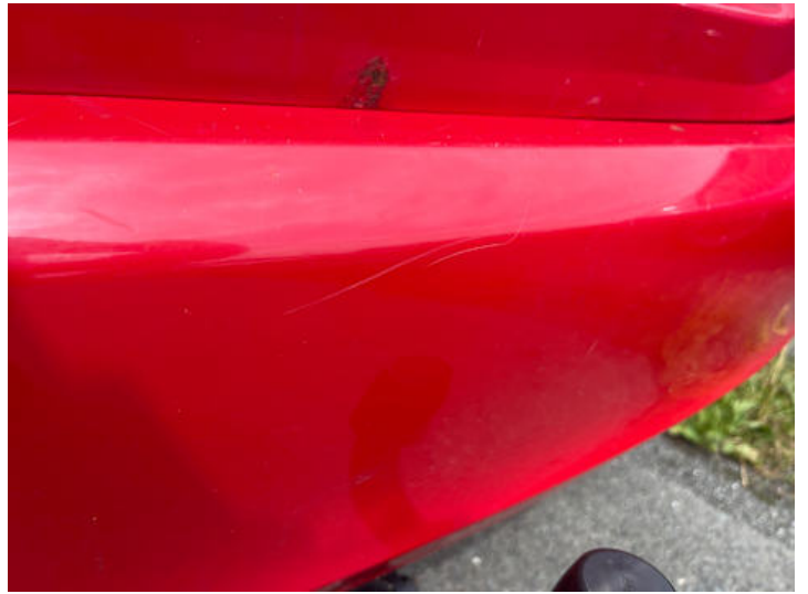
Stoßstange hinten (Lackschaden, Kratzer)
