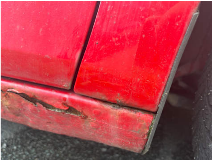
Kotflügel vorne rechts (Rost)
