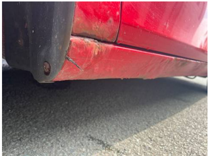
Schweller links (Rost)
