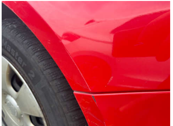
Kotflügel vorne rechts (Lackschaden, Kratzer)
