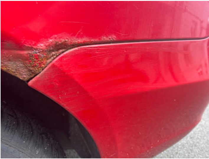
Stoßstange hinten (Lackschaden, Kratzer, Unsachgemäß instand gesetzt)
