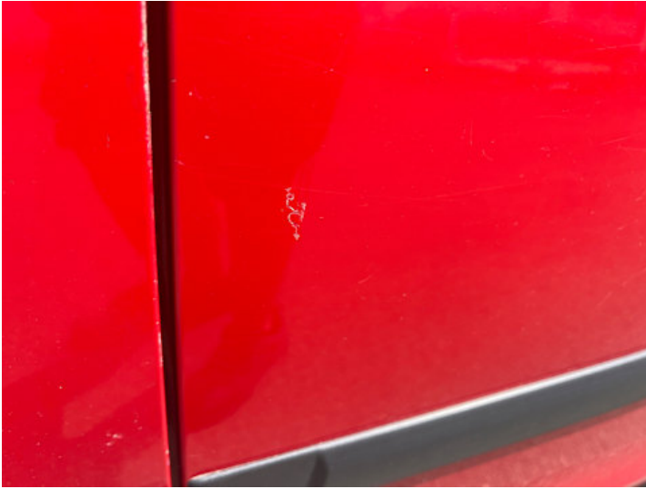
Türe hinten links (Lackschaden)
