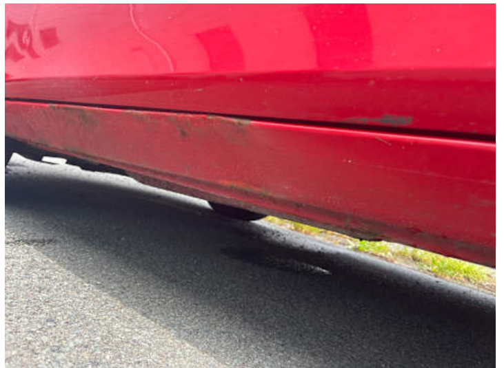
Schweller links (Verformung)
