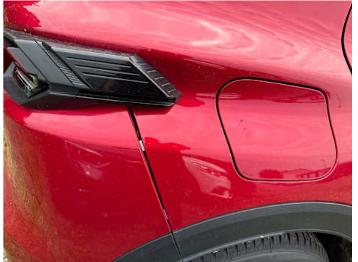
Seitenteil hinten rechts (Spaltmaße ungenau)
