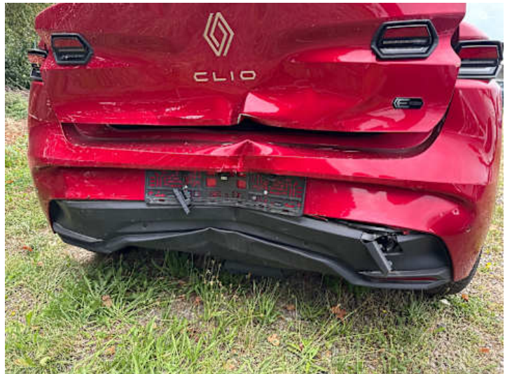
Stoßstange hinten (Verformung, Lackschaden, Riss/Bruch)
