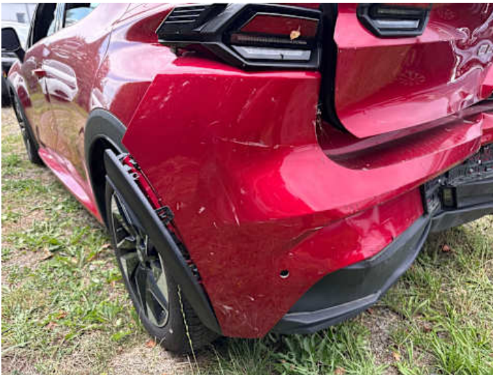
Stoßstange hinten (Verformung, Lackschaden, Riss/Bruch)
