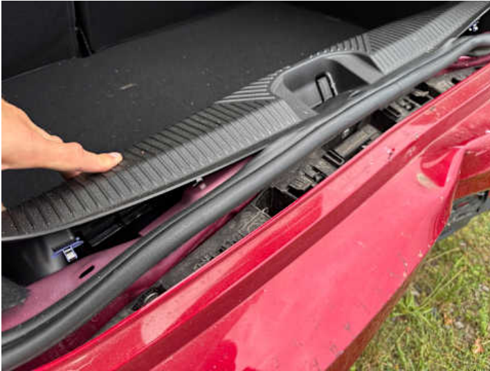
Stoßstange hinten (Verformung, Lackschaden, Riss/Bruch)
