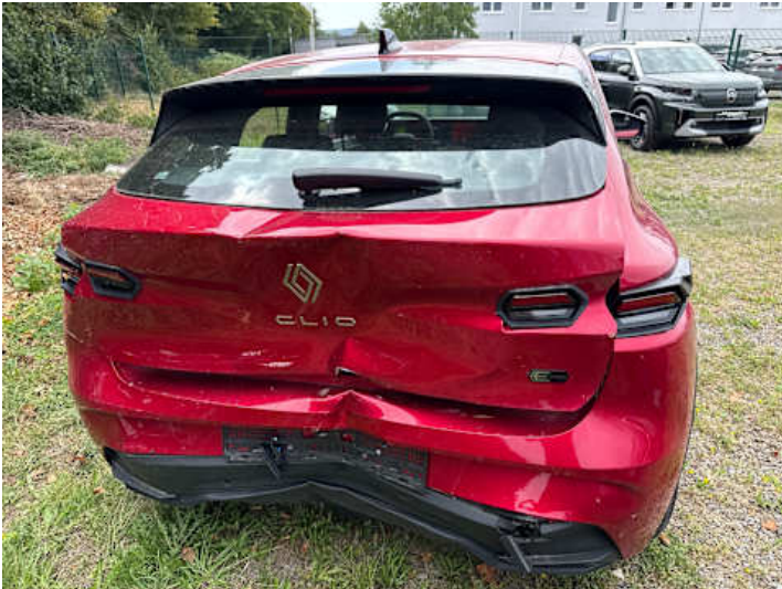
Heckklappe (Verformung, Riss/Bruch, Lackschaden)
