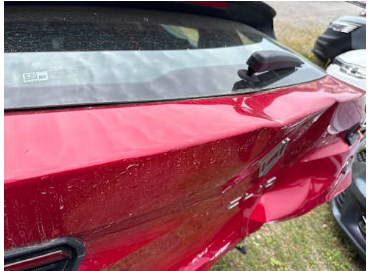
Heckklappe (Verformung, Riss/Bruch, Lackschaden)
