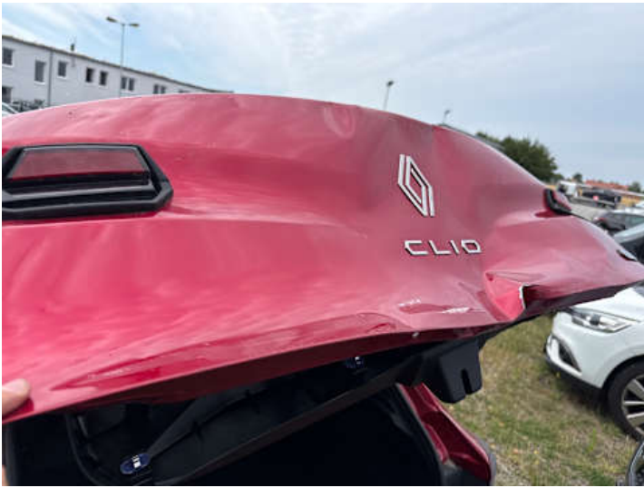
Heckklappe (Verformung, Riss/Bruch, Lackschaden)
