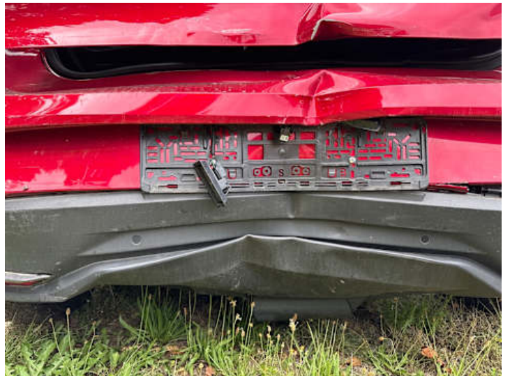
Stoßstange hinten (Verformung, Lackschaden, Riss/Bruch)
