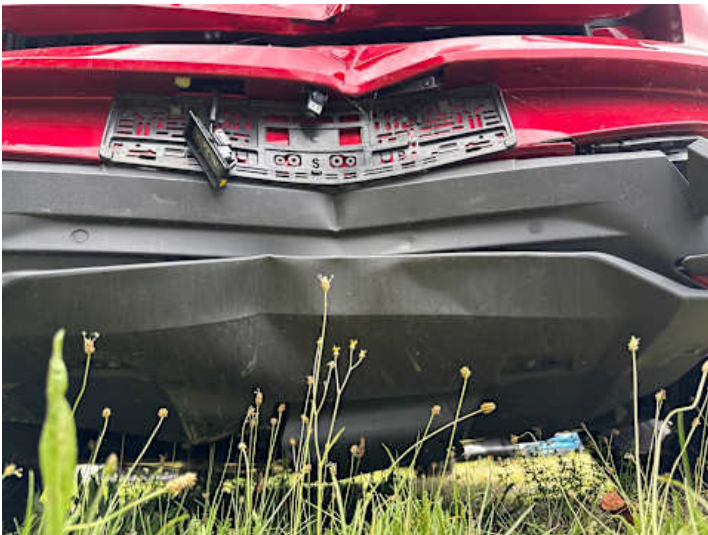
Stoßstange hinten (Verformung, Lackschaden, Riss/Bruch)
