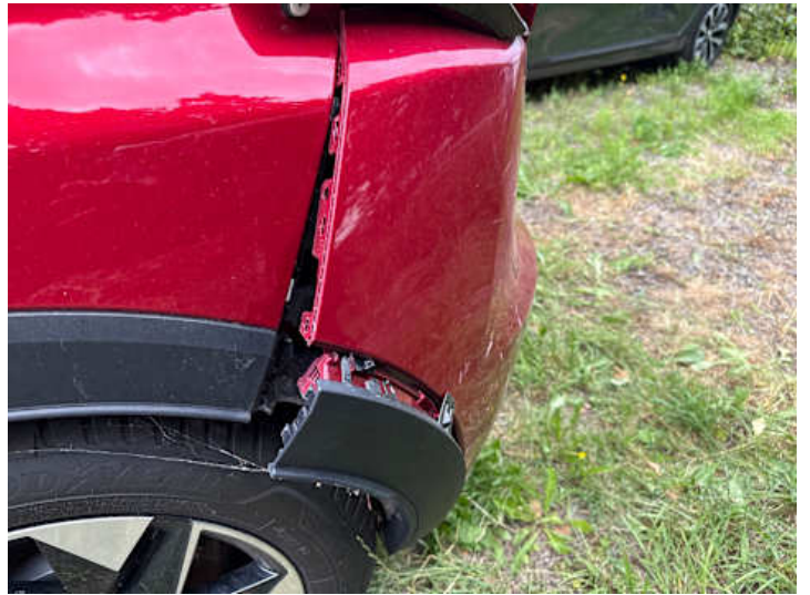
Stoßstange hinten (Verformung, Lackschaden, Riss/Bruch)
