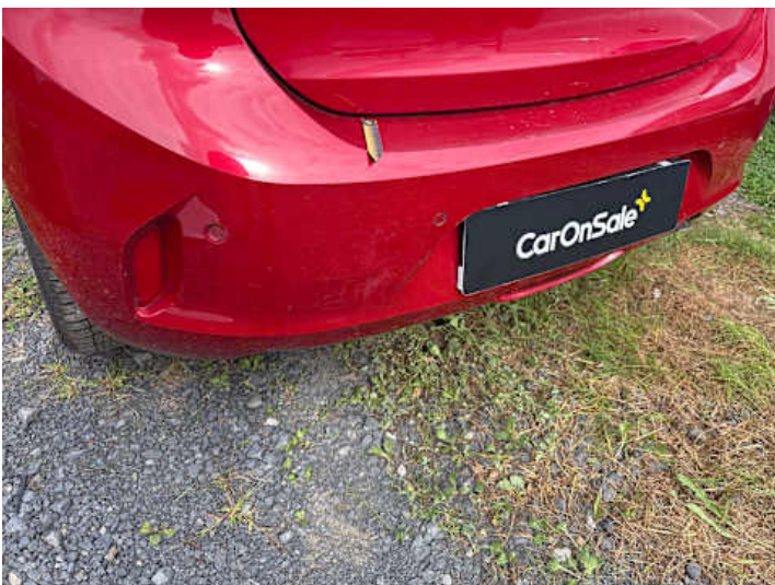
Stoßstange hinten (Riss/Bruch)
