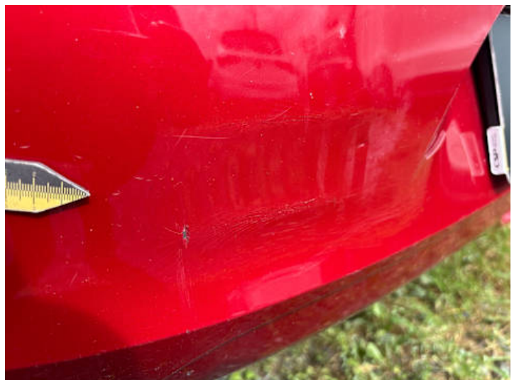
Stoßstange hinten (Riss/Bruch)
