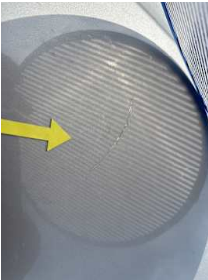
Motorhaube (Delle, Kratzer)
