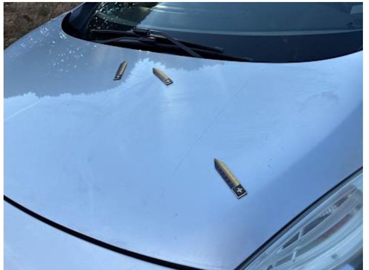
Motorhaube (Lackschaden, Kratzer)
