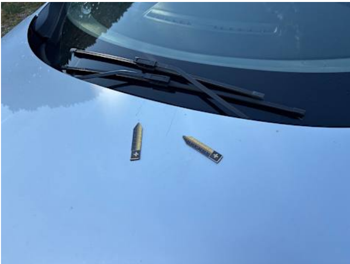
Motorhaube (Lackschaden, Kratzer)
