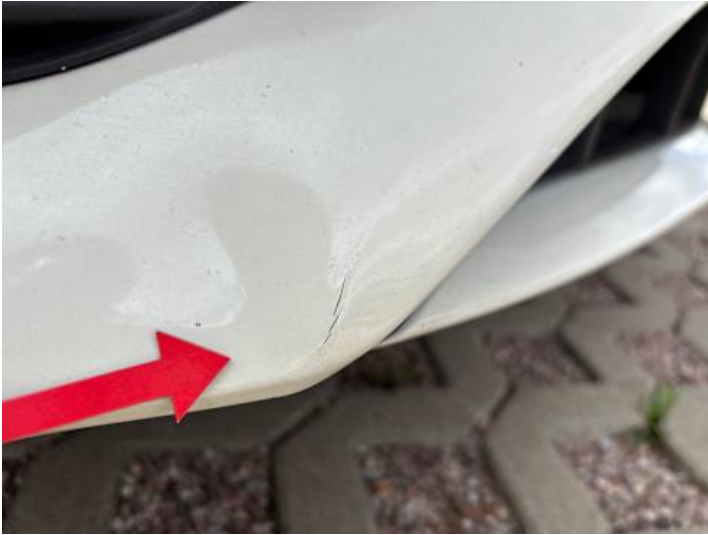
Stoßstange vorne (Lackschaden, Riss/Bruch)
