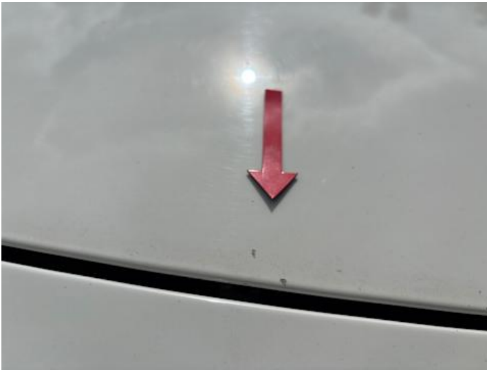
Motorhaube (Steinschlag, Lackschaden)
