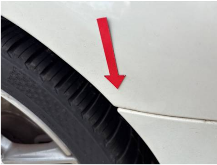
Seitenteil hinten links (Spaltmaße ungenau)
