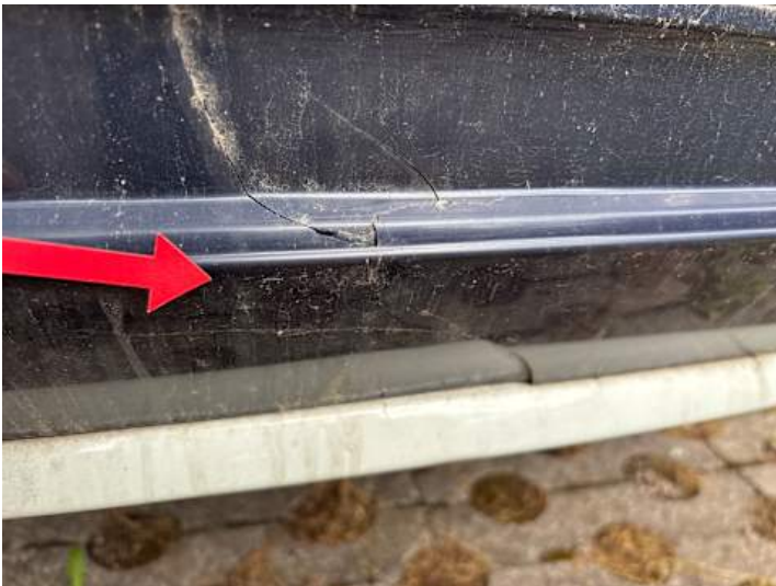
Stoßstange hinten (Riss/Bruch)
