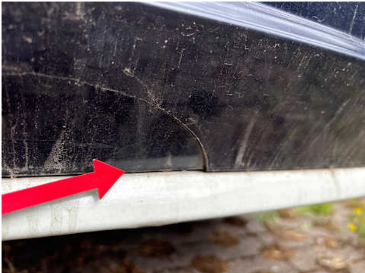
Stoßstange hinten (Riss/Bruch)
