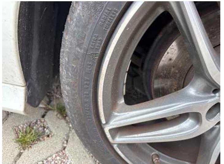
Rad (Anderer Schaden): Verfärbung
