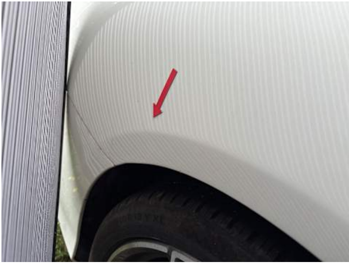
Seitenteil hinten rechts (Delle)
