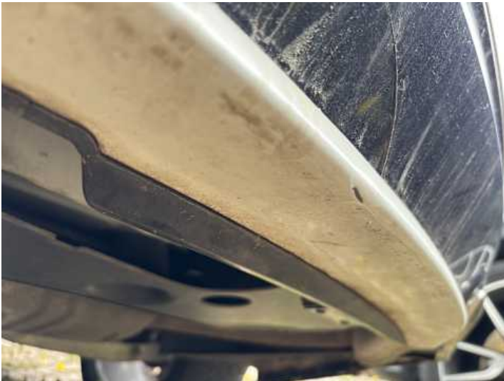
Stoßstange hinten (Delle, Lackschaden)
