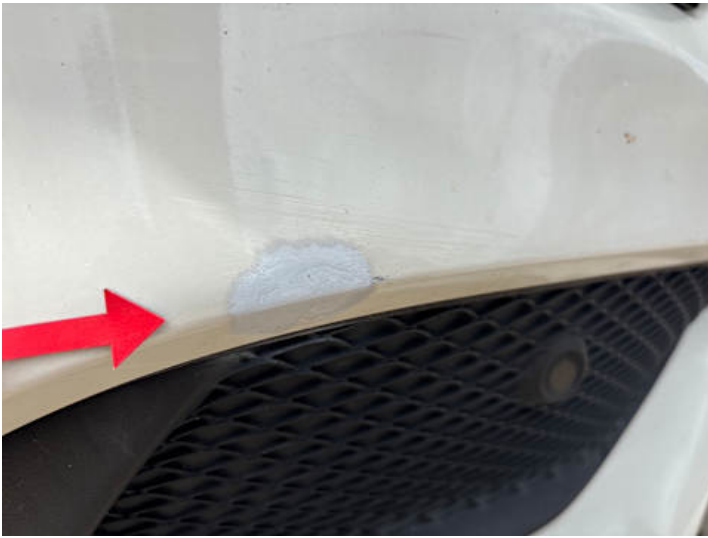
Stoßstange vorne (Lackschaden, Unsachgemäß instand gesetzt)
