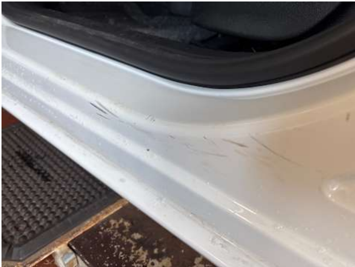
Schweller links (Kratzer)
