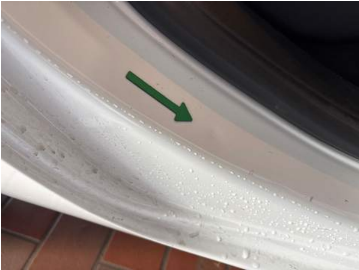
Schweller rechts (Kratzer, Delle)
