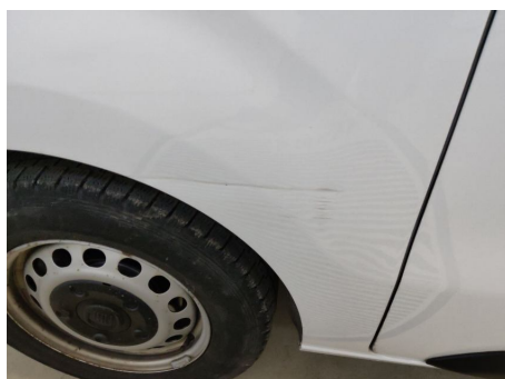
Kotflügel / Hinten Rechts / Kratzer
