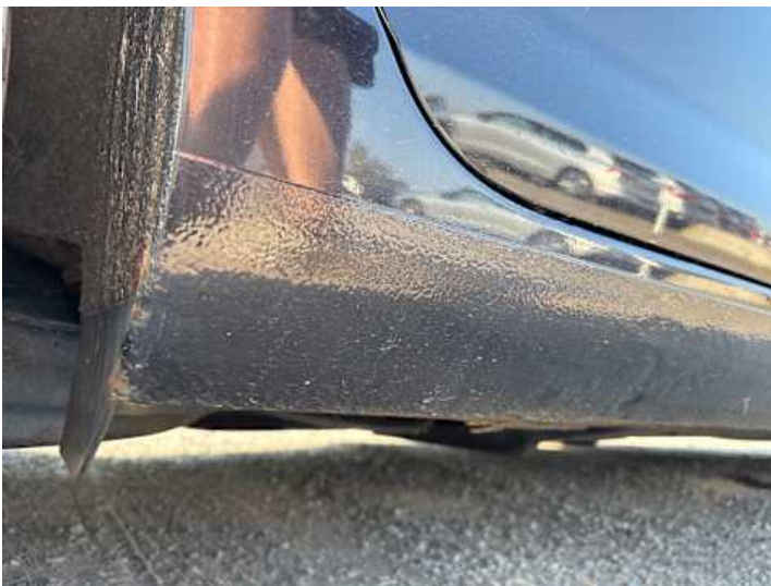
Schweller rechts (Rost)
