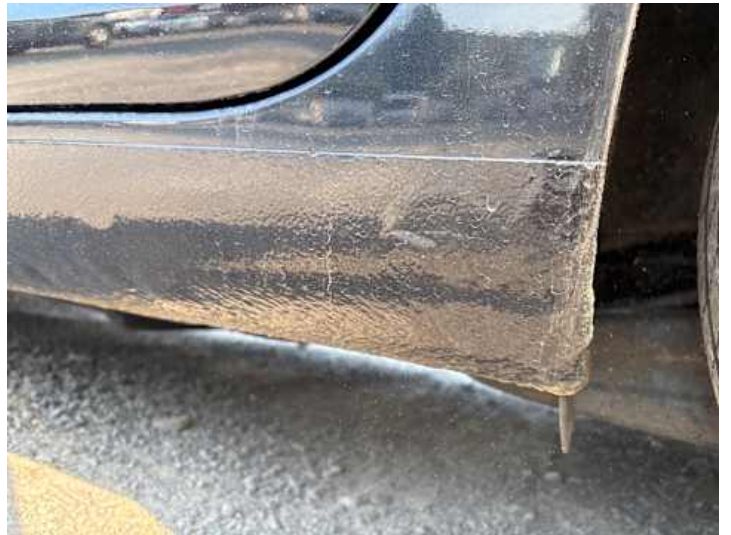
Schweller links (Rost)
