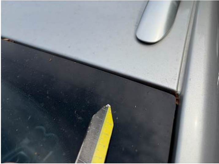
Dach (Lackschaden, Steinschlag)
