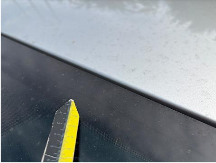
Dach (Lackschaden, Steinschlag)
