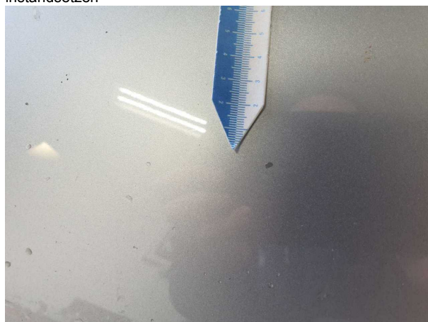
Beschädigung 2: Motorhaube: Motorhaube (Auslegen/Polieren) - Steinschlag - Smart Repair
