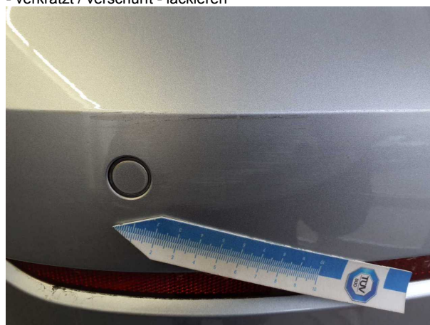
Beschädigung 9: Stossfänger hinten: Stossfänger hinten links - verkratzt / verschürft - lackieren
