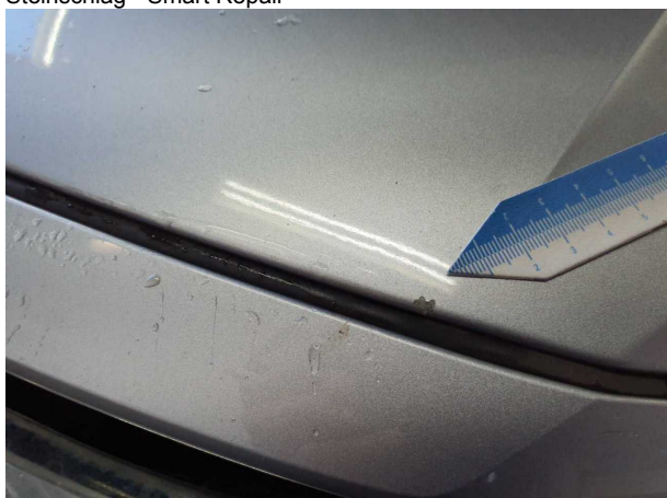
Beschädigung 2: Motorhaube: Motorhaube (Auslegen/Polieren) - Steinschlag - Smart Repair
