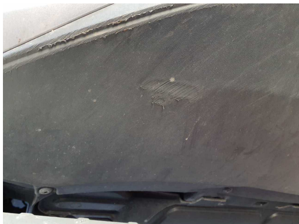
Beschädigung 8: Stossfänger vorn: Spoiler - verkratzt / verschürft - erneuern
