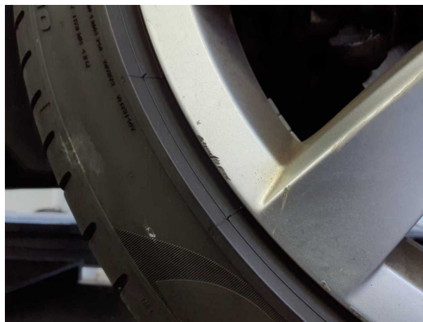
Gebrauchsspur 2: Rad/Reifen: Leichtmetallfelge hinten links - Kratzer - kein Abzug
