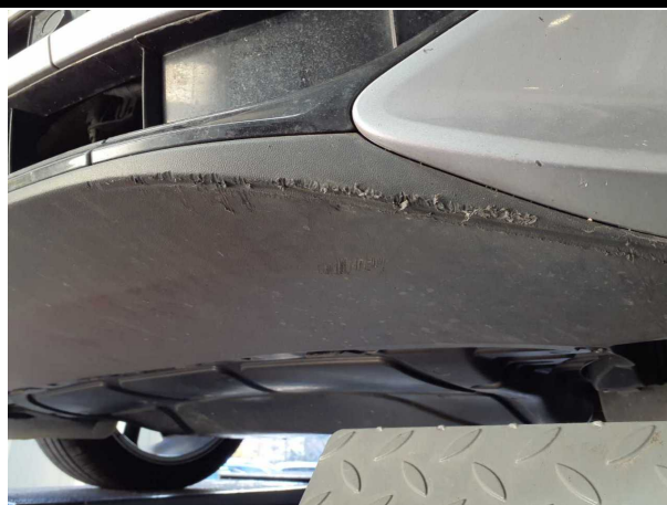
Beschädigung 8: Stossfänger vorn: Spoiler - verkratzt / verschürft - erneuern
