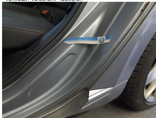
Beschädigung 10: Karosserie: C-Säule links - verkratzt / verschürft - lackieren
