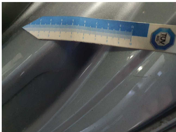
Beschädigung 10: Karosserie: C-Säule links - verkratzt / verschürft - lackieren
