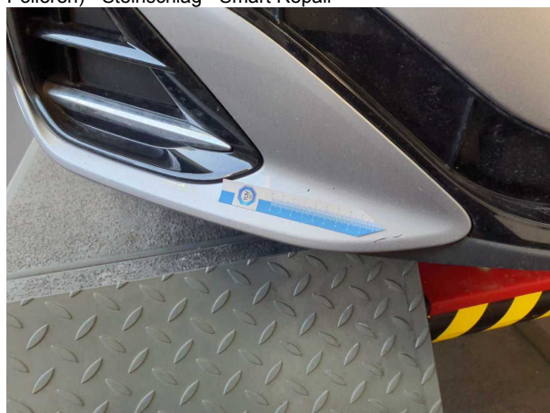
Beschädigung 3: Stossfänger vorn rechts - verkratzt / verschürft - Smart Repair
