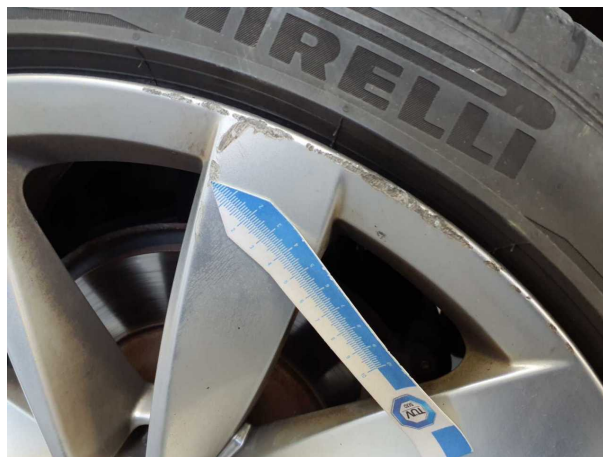
Beschädigung 6: Rad/Reifen: Leichtmetallfelge hinten rech... verkratzt / verschürft - Wertminderung
