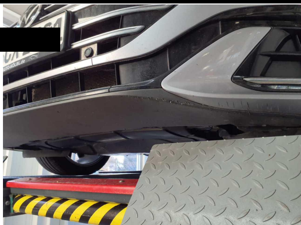
Beschädigung 8: Stossfänger vorn: Spoiler - verkratzt / verschürft - erneuern
