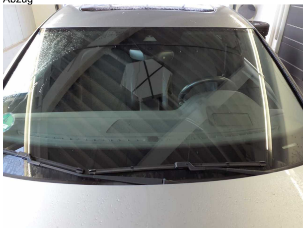
Gebrauchsspur 5: Verglasung: Frontscheibe (Ohne Rissbildung) - Steinschlag - kein Abzug
