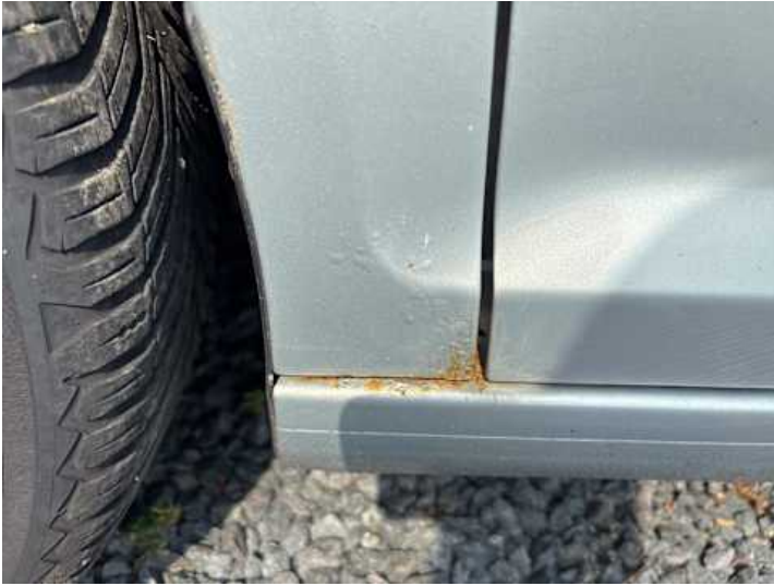
Kotflügel vorne links (Rost)
