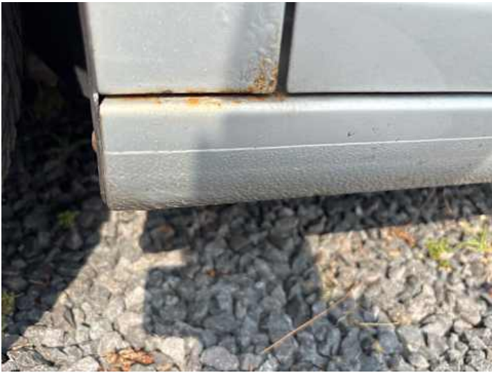
Schweller links (Rost)
