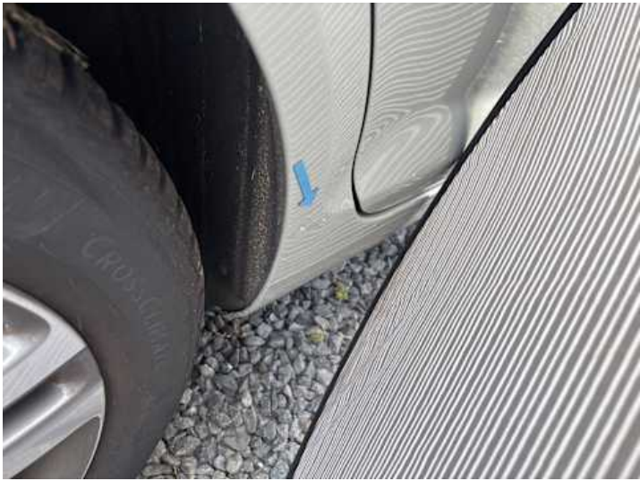
Seitenteil hinten rechts (Delle, Lackschaden)
