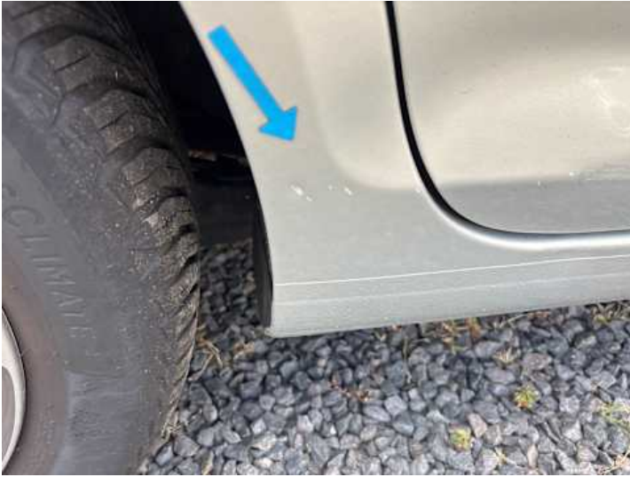
Seitenteil hinten rechts (Delle, Lackschaden)
