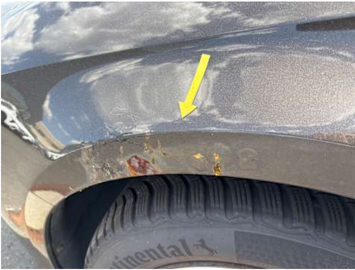
Kotflügel vorne links (Rost)
