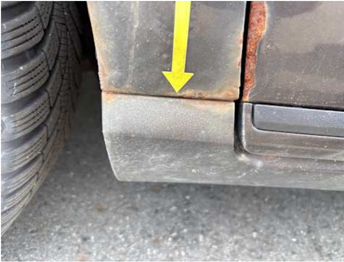
Schweller links (Rost)
