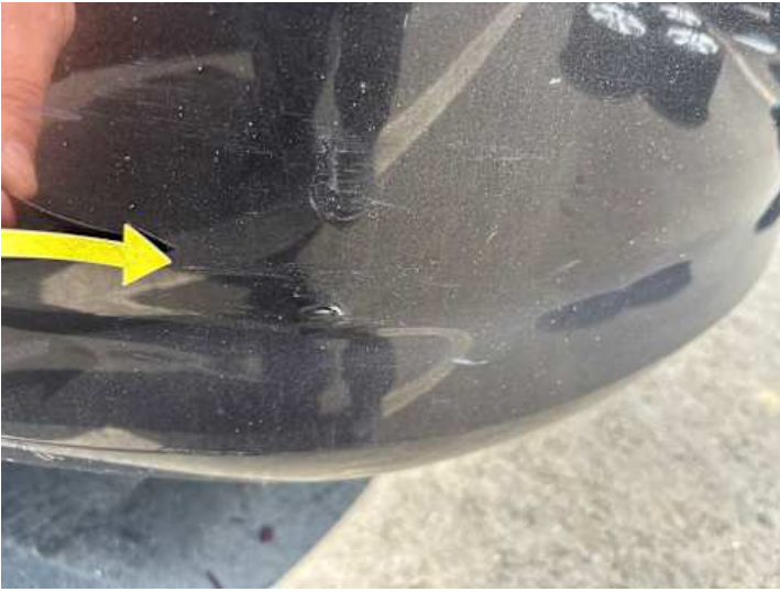
Stoßstange hinten (Lackschaden, Kratzer, Verformung)
