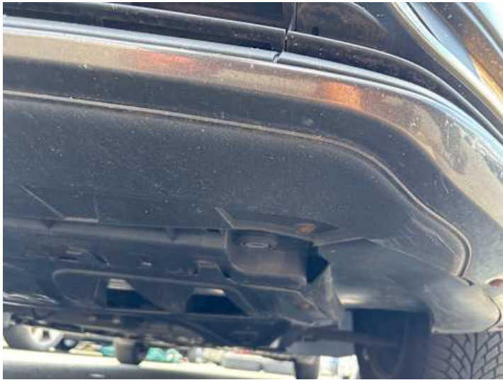
Stoßstange vorne (Kratzer, Lackschaden)
