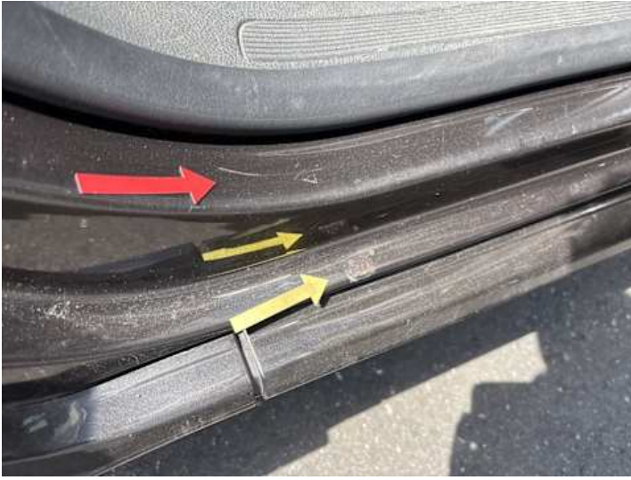
Schweller rechts (Rost, Kratzer)
