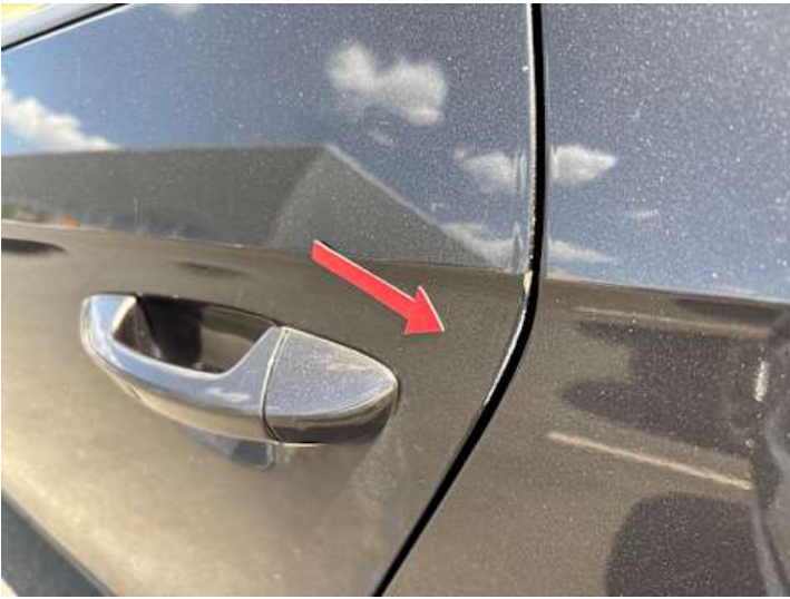
Türe hinten links (Rost, Lackschaden)
