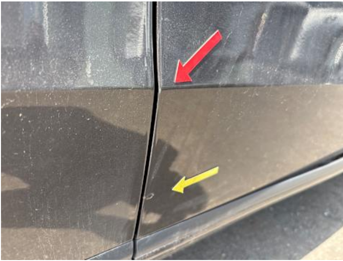
Beifahrertür (Lackschaden, Rost)
