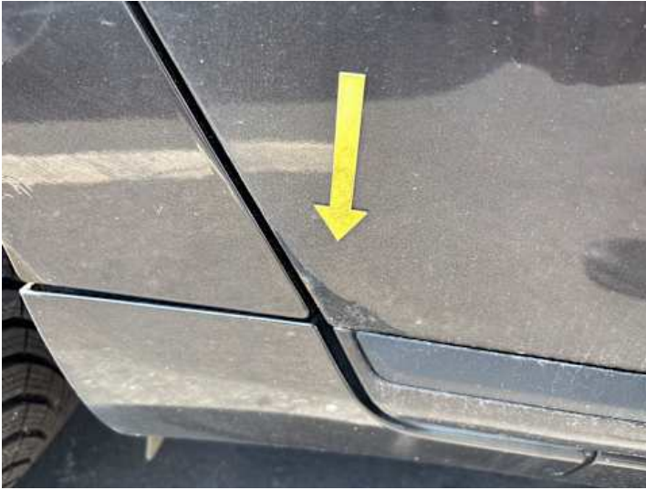
Türe hinten rechts (Rost)
