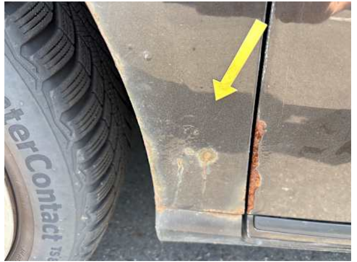
Kotflügel vorne links (Rost)
