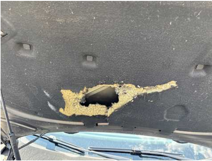
Motorhaube (Anderer Schaden): Dämmmatte beschädigt
