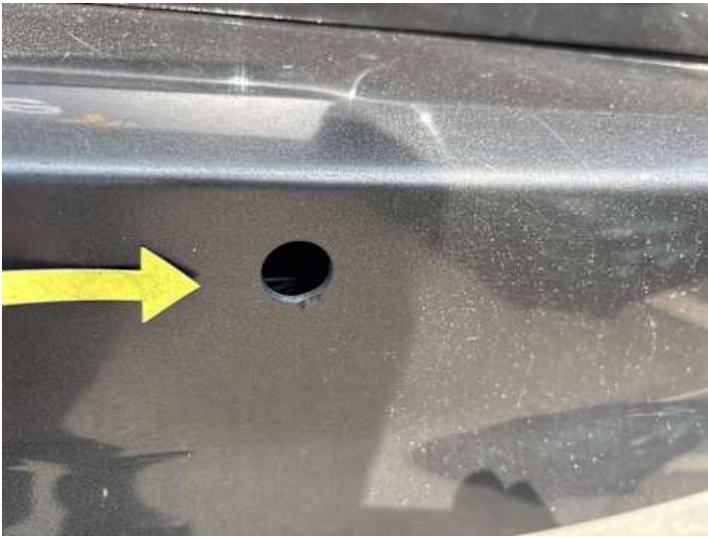
Stoßstange hinten (Anderer Schaden): Sensor Einparkhilfe eingedrückt
