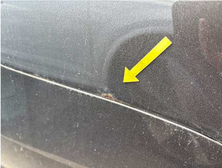
Seitenteil hinten rechts (Rost)
