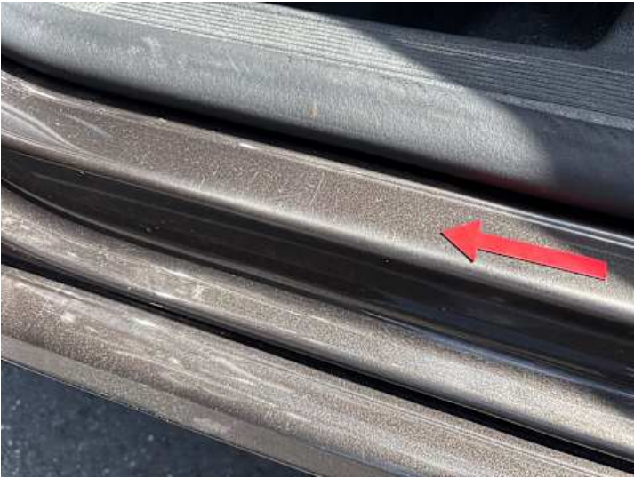
Schweller links (Rost)
