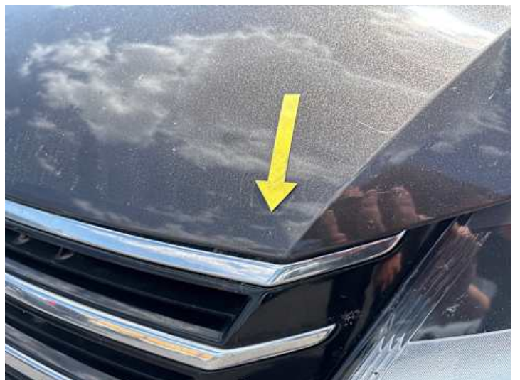
Motorhaube (Rost, Lackschaden)
