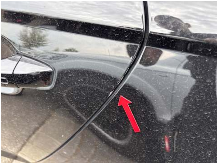
Türe hinten links (Kratzer)
