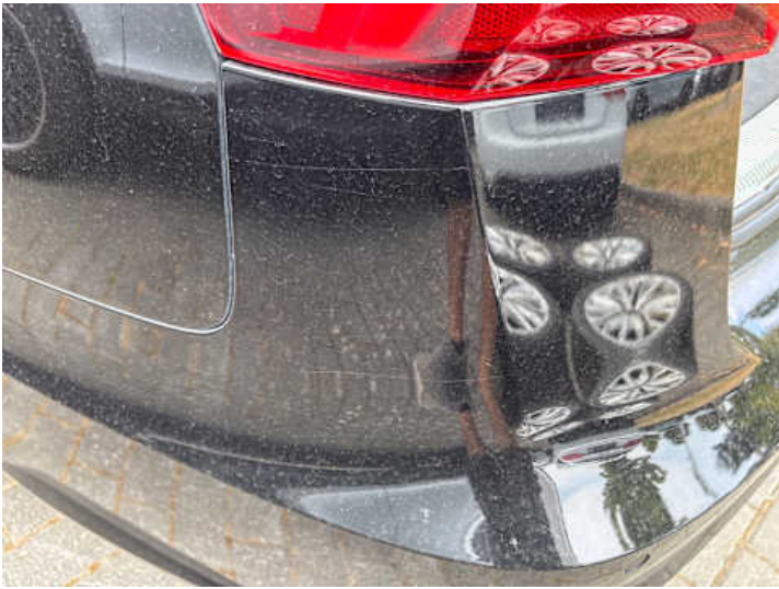
Stoßstange hinten (Kratzer)
