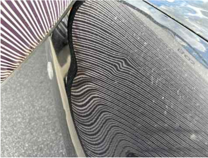
Kotflügel vorne rechts (Verformung)
