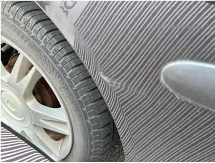
Seitenteil hinten rechts (Verformung, Lackschaden)
