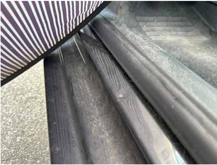
Schweller links (Verformung)
