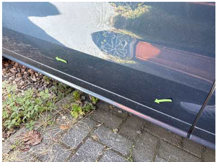
Fahrtür (Kratzer, Delle)
