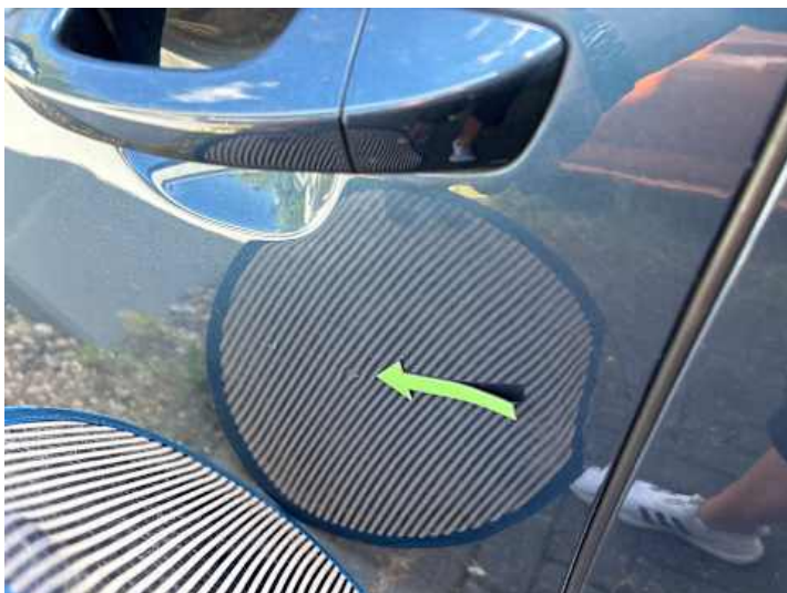
Fahrtür (Kratzer, Delle)
