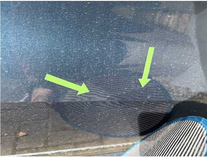
Türe hinten rechts (Delle)
