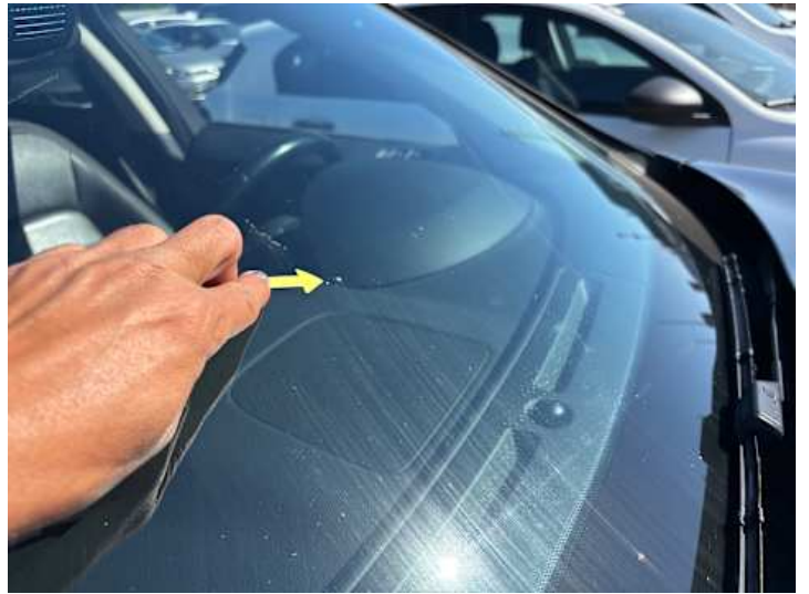
Windschutzscheibe (Steinschlag, Riss/Bruch)
