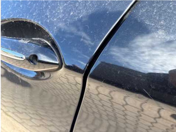
Fahrtür (Lackschaden, Kratzer)
