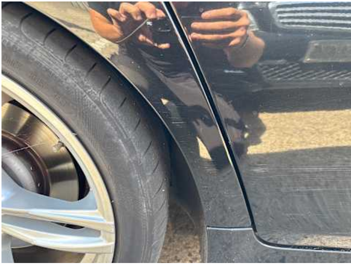
Seitenteil hinten rechts (Kratzer, Lackschaden, Delle)
