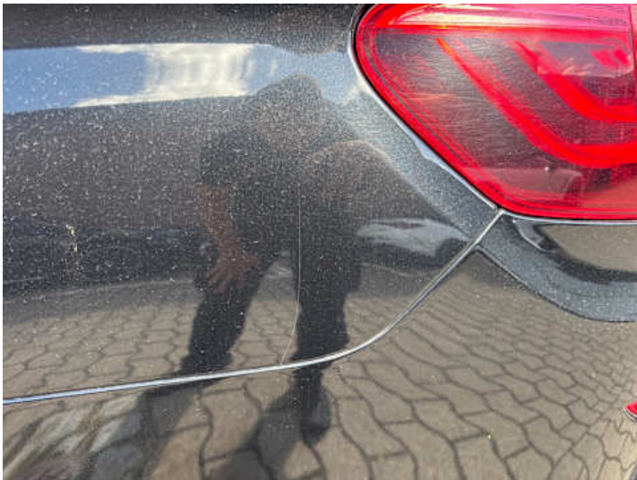
Seitenteil hinten links (Kratzer, Delle, Lackschaden)
