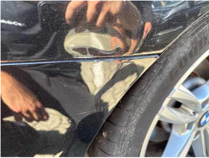
Stoßstange hinten (Lackschaden, Kratzer, Riss/Bruch)
