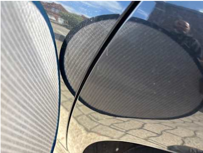
Seitenteil hinten links (Kratzer, Delle, Lackschaden)
