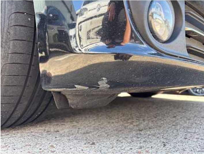
Stoßstange vorne (Lackschaden, Kratzer)
