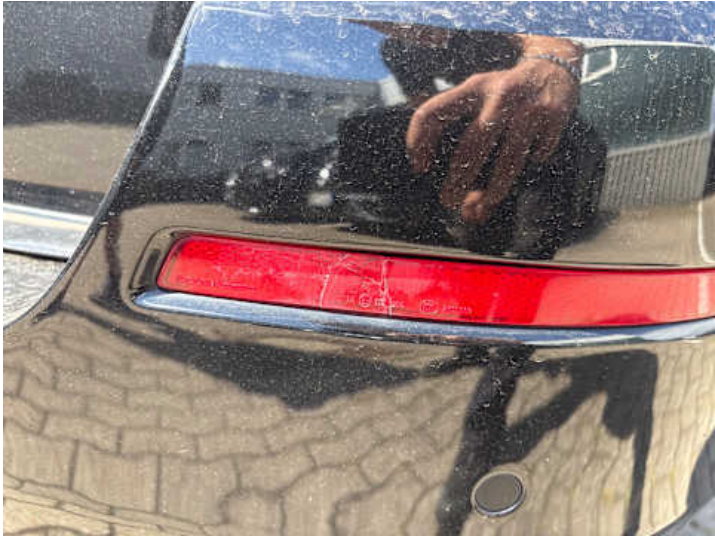
Stoßstange hinten (Lackschaden, Kratzer, Riss/Bruch)
