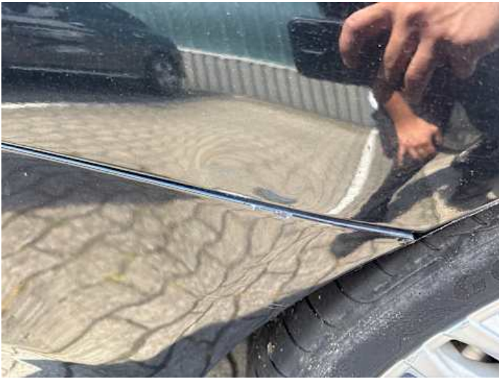
Seitenteil hinten rechts (Kratzer, Lackschaden, Delle)
