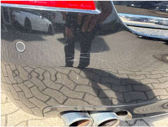
Stoßstange hinten (Lackschaden, Kratzer, Riss/Bruch)
