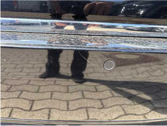
Stoßstange hinten (Lackschaden, Kratzer, Riss/Bruch)
