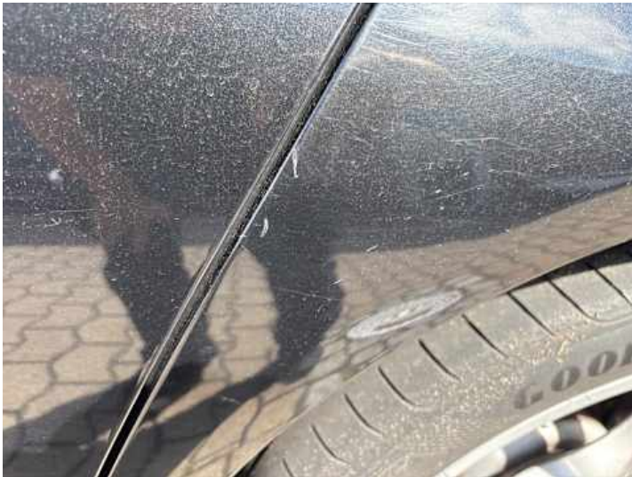
Seitenteil hinten links (Kratzer, Delle, Lackschaden)
