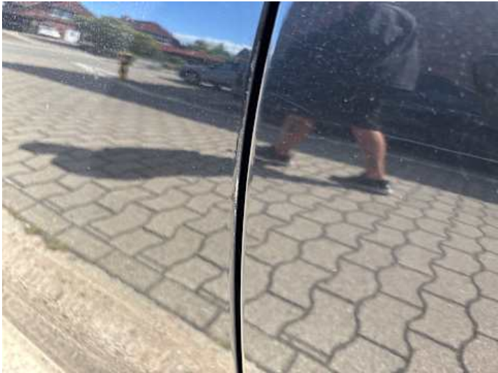
Fahrtür (Lackschaden, Kratzer)
