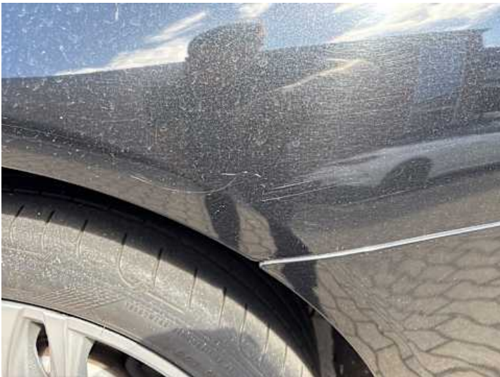
Seitenteil hinten links (Kratzer, Delle, Lackschaden)
