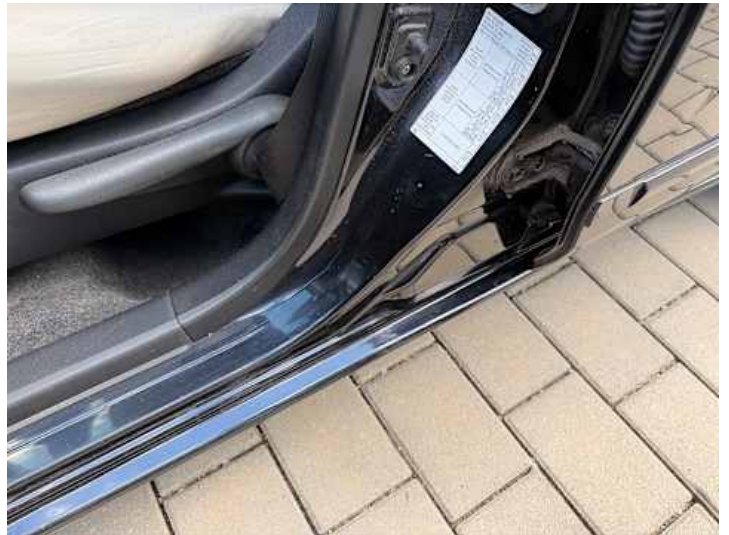
Fahrertür (Kratzer, Delle)
