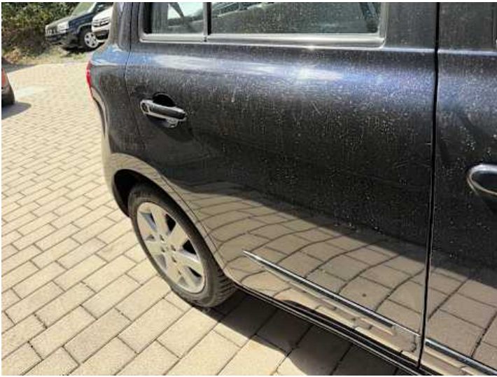
Türe hinten rechts (Kratzer, Delle)
