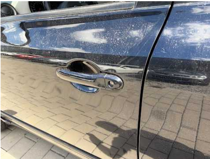
Fahrertür (Kratzer, Delle)
