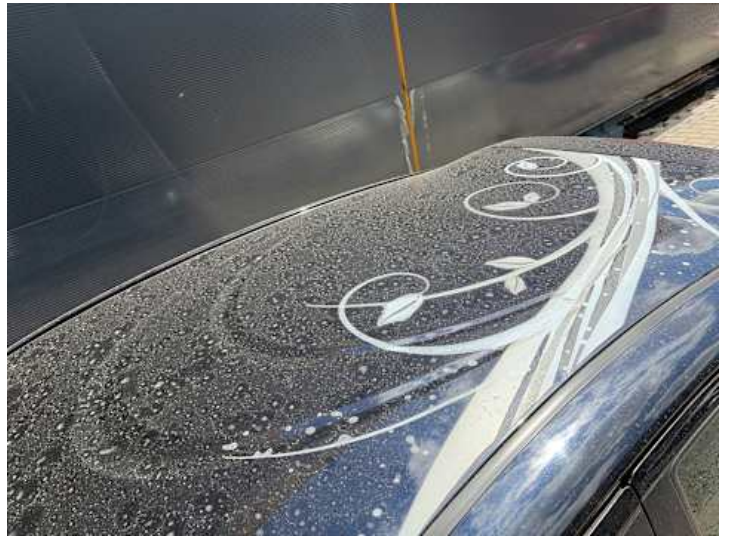
Dach (Anderer Schaden): Aufkleber löst sich;
