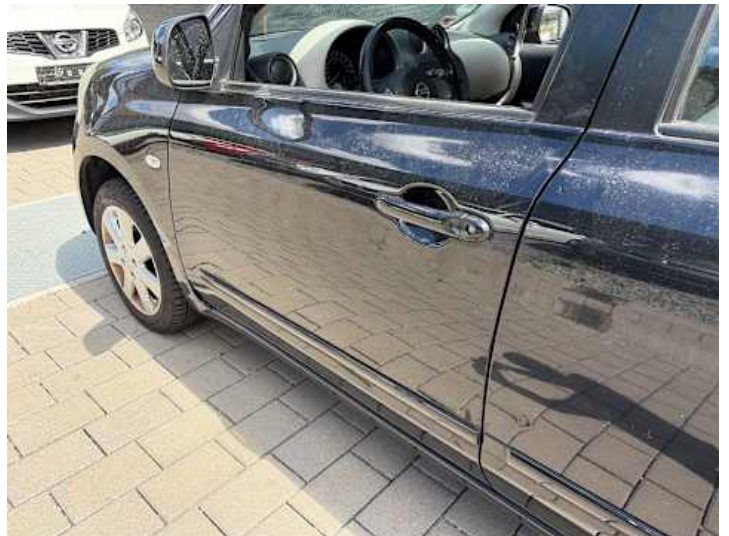
Fahrertür (Kratzer, Delle)
