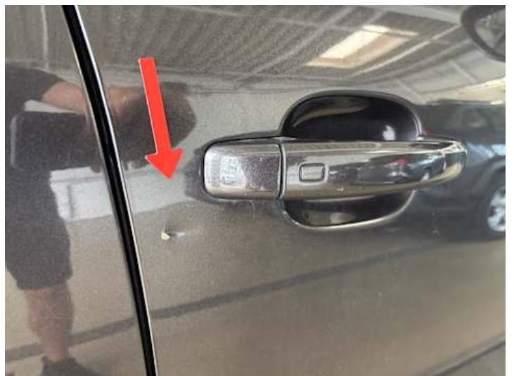
Beifahrertür (Verformung, Kratzer, Lackschaden)
