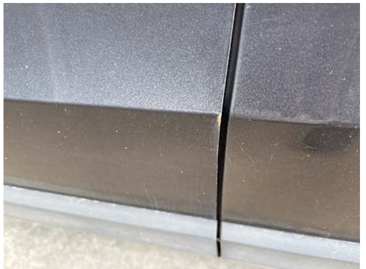
Fahrertür (Kratzer, Rost)
