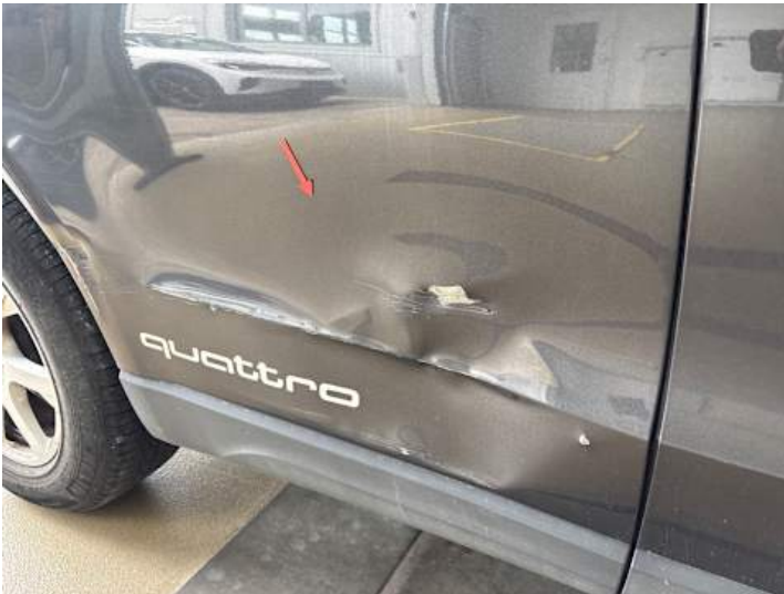
Türe hinten rechts (Verformung, Kratzer, Lackschaden)
