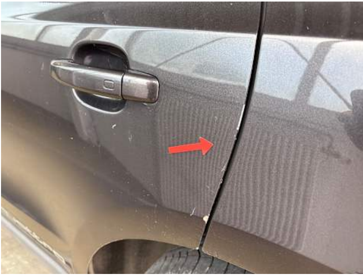
Türe hinten links (Kratzer, Lackschaden)
