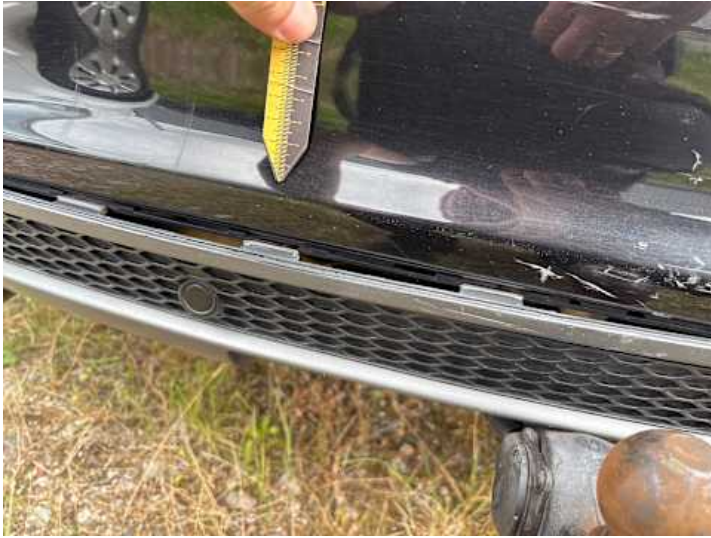
Stoßstange hinten (Riss/Bruch)
