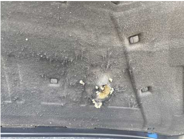
Motorhaube (Anderer Schaden): Dämmung beschädigt
