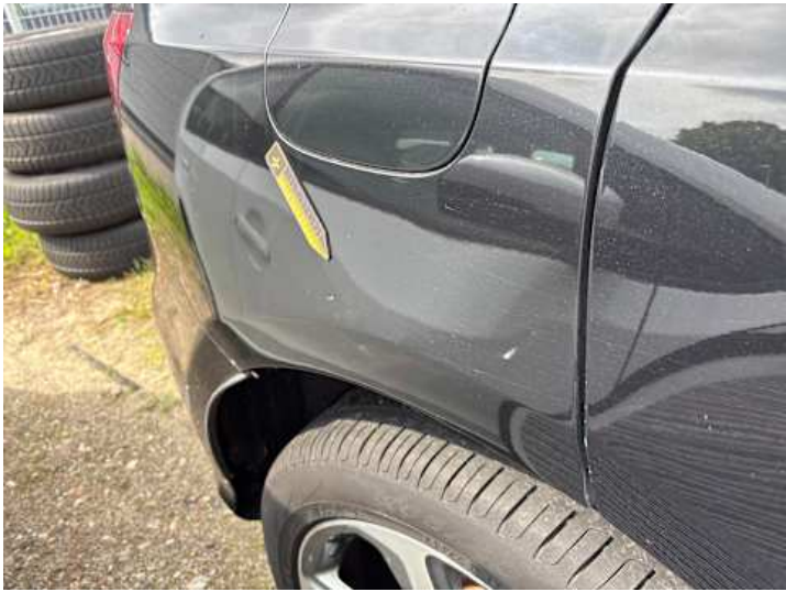
Seitenteil hinten rechts (Delle)
