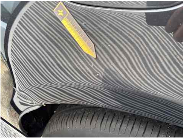
Seitenteil hinten rechts (Delle)
