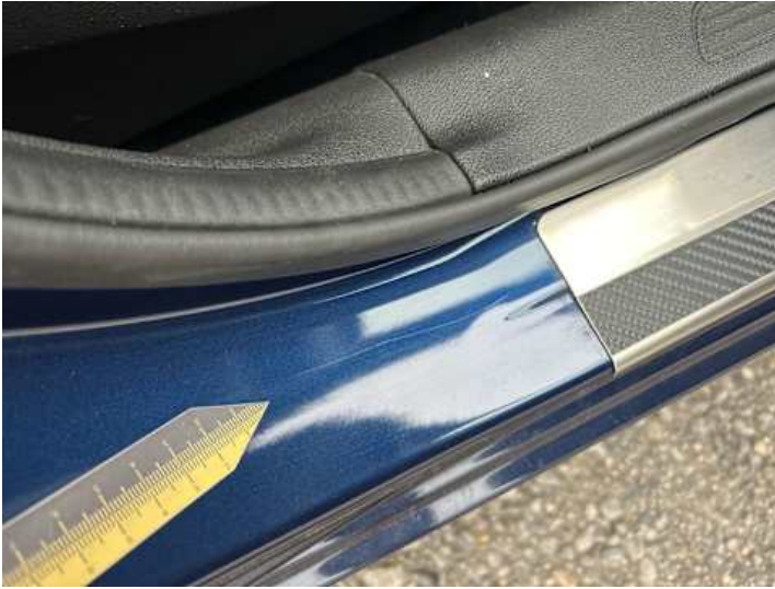
Schweller rechts (Kratzer)
