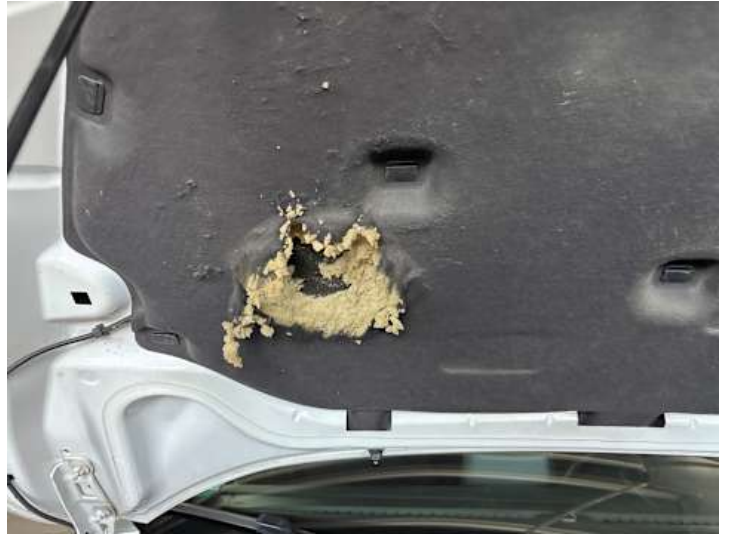
Motorhaube (Anderer Schaden): Dämmmatte angefressen
