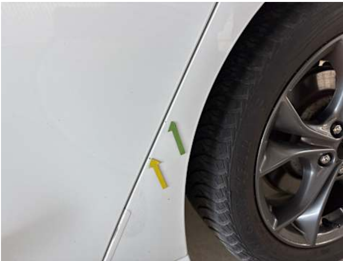
Seitenteil hinten links (Steinschlag)
