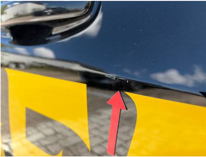
Beifahrertür (Delle, Lackschaden, Kratzer)
