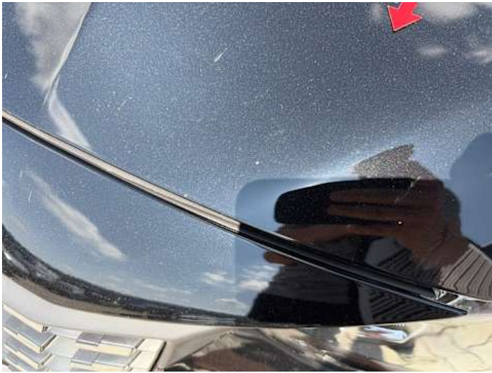
Motorhaube (Steinschlag, Lackschaden)
