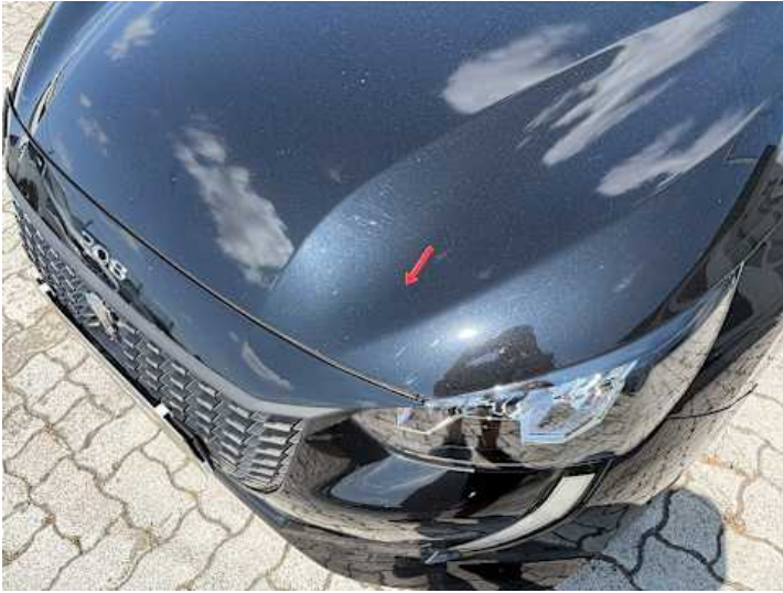
Motorhaube (Steinschlag, Lackschaden)
