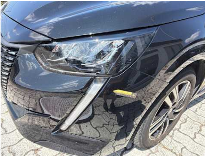
Stoßstange vorne (Spaltmaße ungenau, Kratzer)
