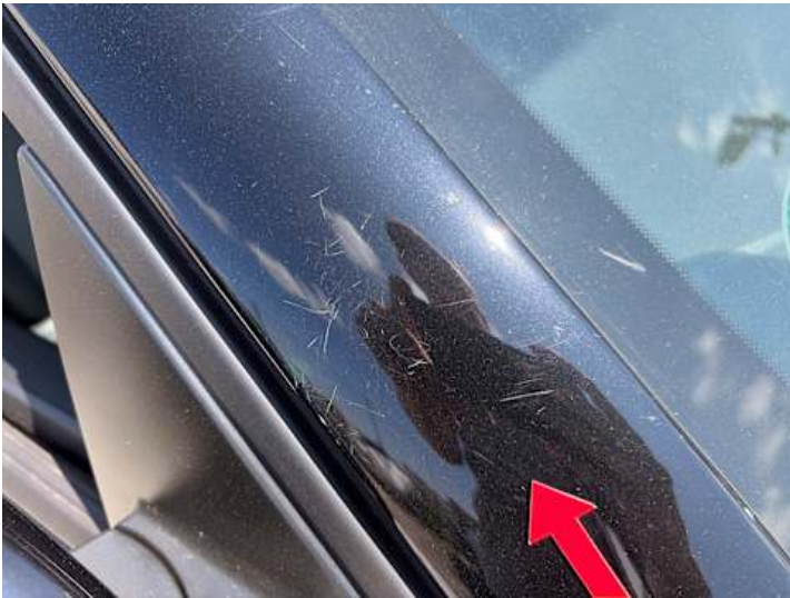
Dach (Kratzer, Lackschaden)
