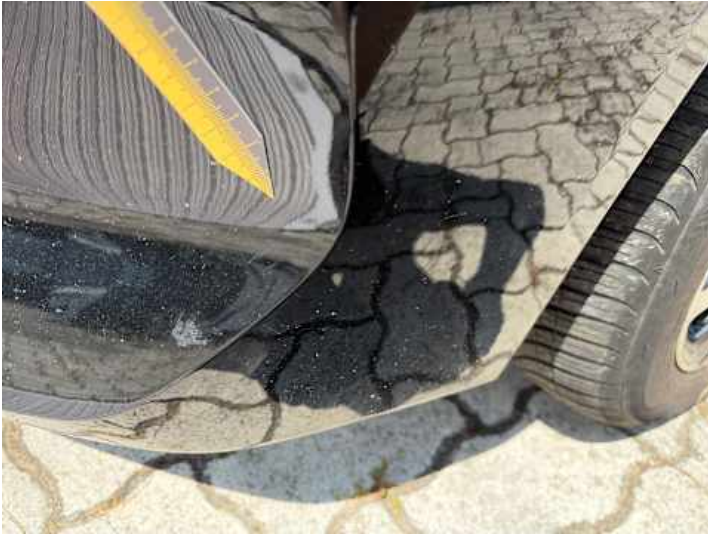
Stoßstange vorne (Spaltmaße ungenau, Kratzer)
