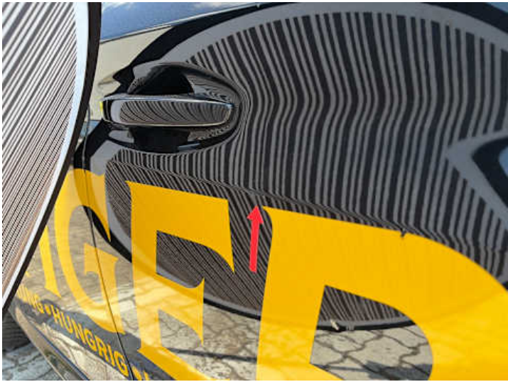
Beifahrertür (Delle, Lackschaden, Kratzer)
