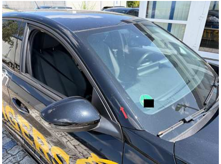
Dach (Kratzer, Lackschaden)
