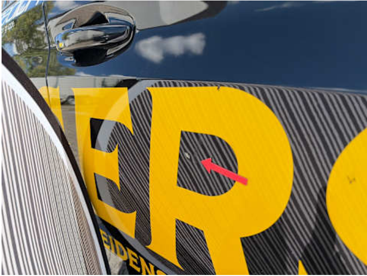
Beifahrertür (Delle, Lackschaden, Kratzer)
