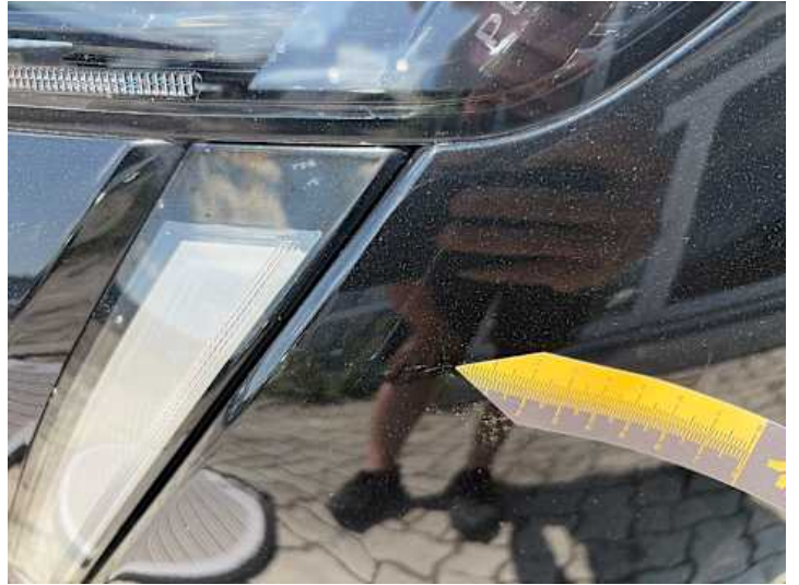
Stoßstange vorne (Spaltmaße ungenau, Kratzer)
