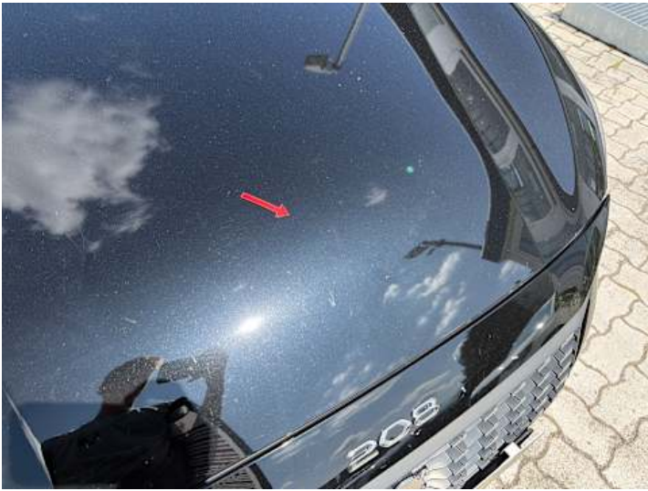
Motorhaube (Steinschlag, Lackschaden)
