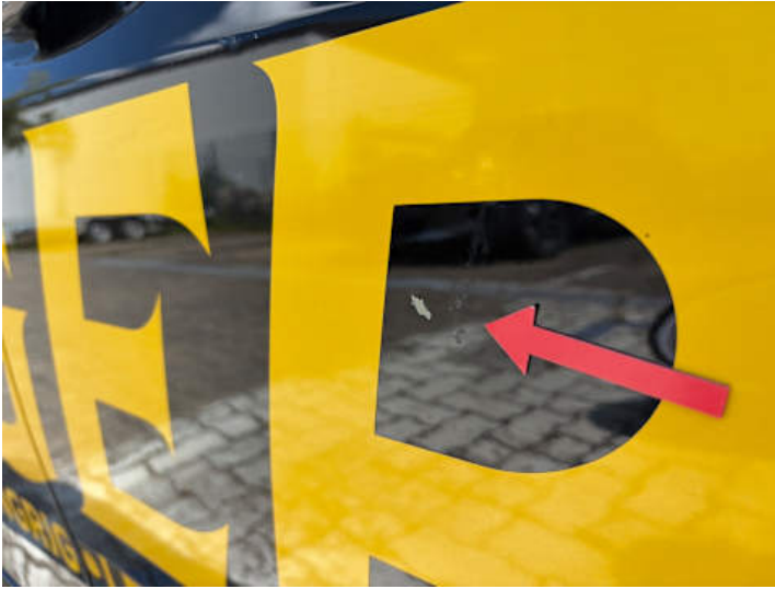
Beifahrertür (Delle, Lackschaden, Kratzer)
