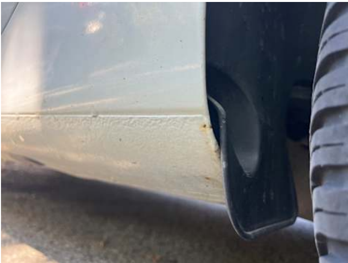
Schweller links (Rost)
