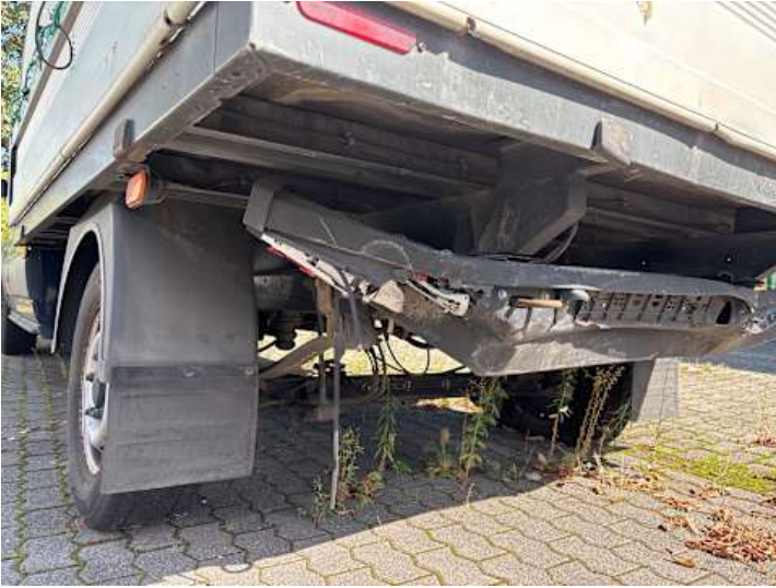
Rücklicht (links) (Riss/Bruch, Anderer Schaden): Fehlt
