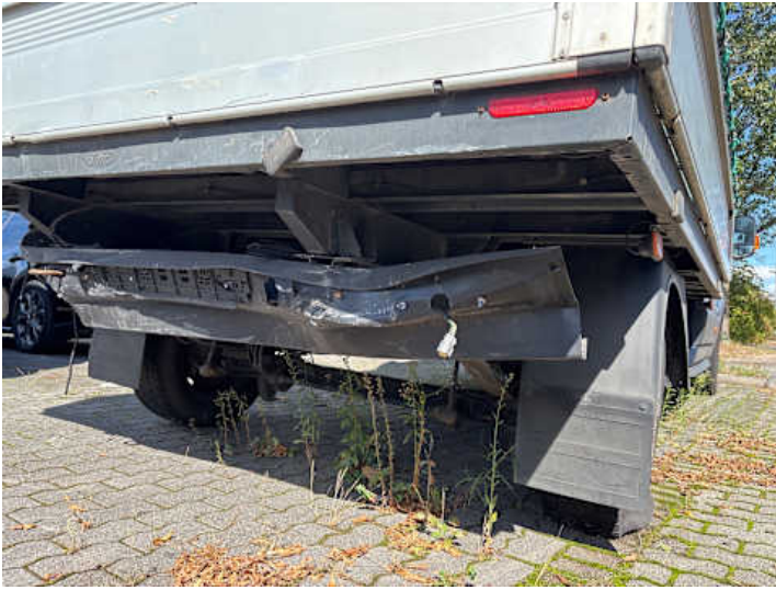
Rücklicht (rechts) (Riss/Bruch, Anderer Schaden): Fehlt
