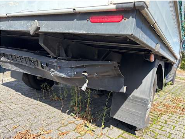
Stoßstange hinten (Verformung, Riss/Bruch)
