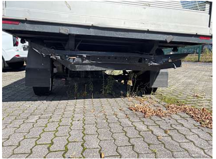
Stoßstange hinten (Verformung, Riss/Bruch)
