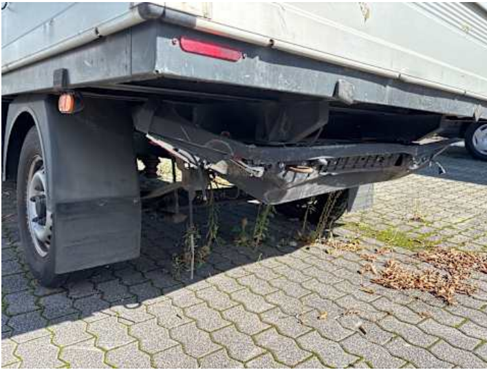
Stoßstange hinten (Verformung, Riss/Bruch)
