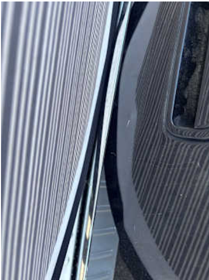
Heckklappe (Delle, Kratzer)
