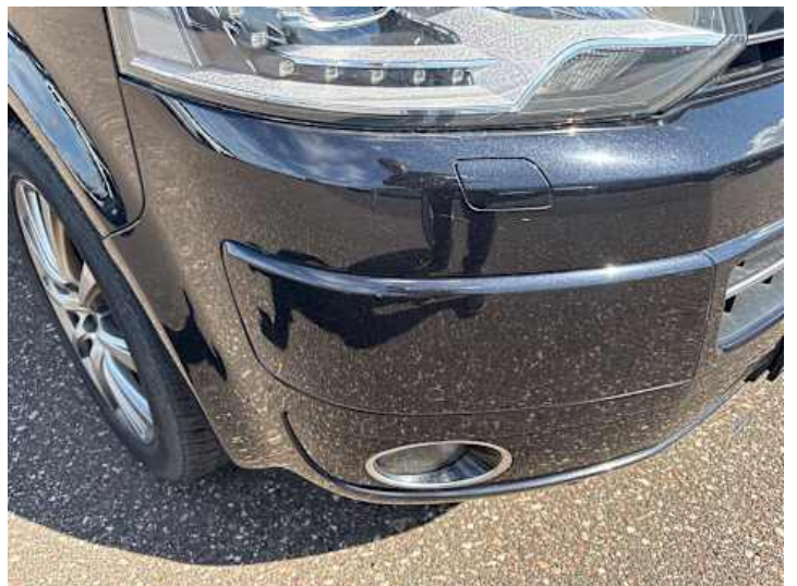
Stoßstange vorne (Kratzer, Spaltmaße ungenau)
