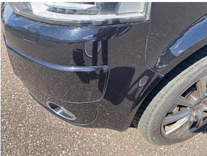
Stoßstange vorne (Kratzer, Spaltmaße ungenau)
