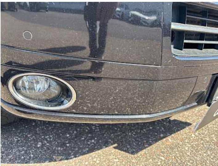
Stoßstange vorne (Kratzer, Spaltmaße ungenau)
