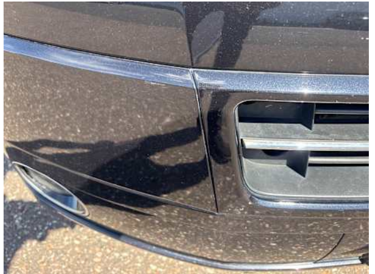
Stoßstange vorne (Kratzer, Spaltmaße ungenau)
