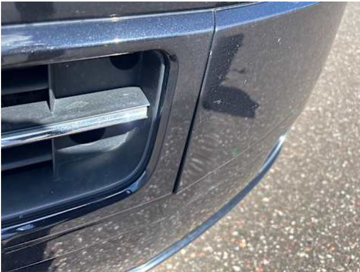
Stoßstange vorne (Kratzer, Spaltmaße ungenau)
