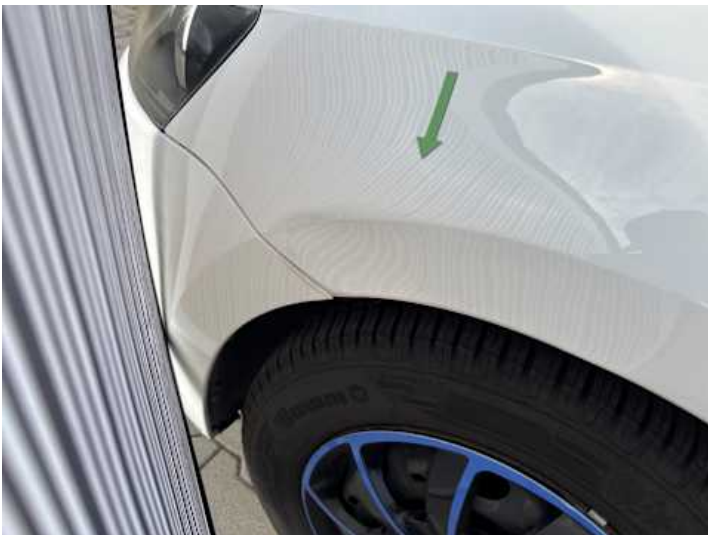
Kotflügel vorne links (Delle)
