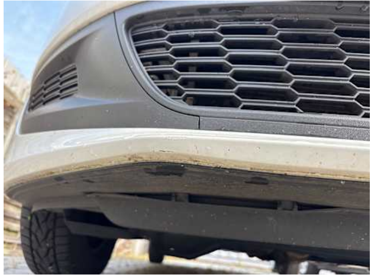
Stoßstange vorne (Kratzer, Lackschaden)
