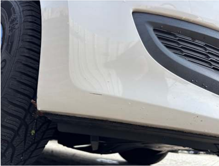
Stoßstange vorne (Kratzer, Lackschaden)
