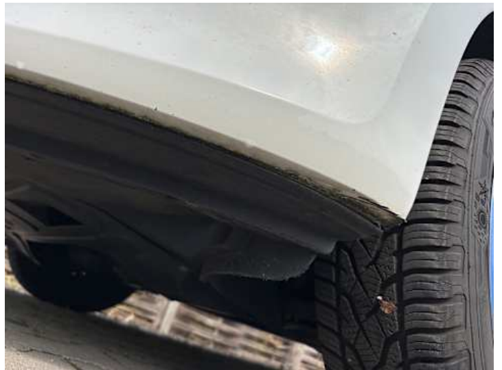
Stoßstange vorne (Kratzer, Lackschaden)
