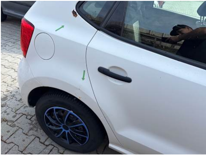
Seitenteil hinten rechts (Lackschaden, Delle, Rost)
