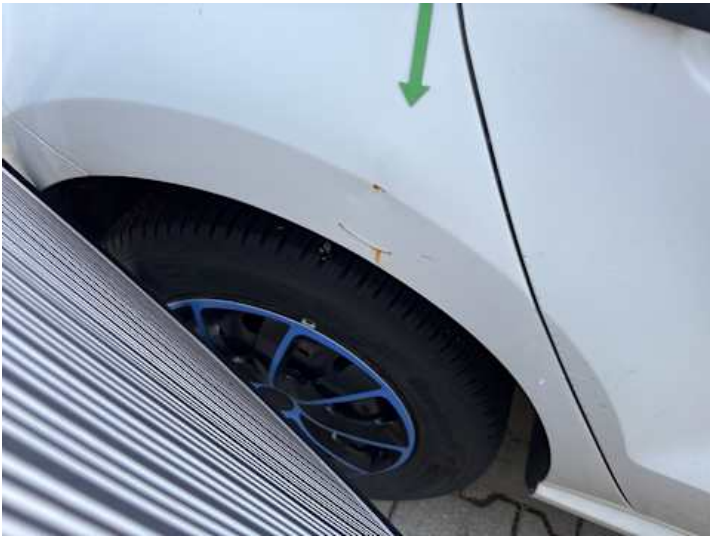
Seitenteil hinten rechts (Lackschaden, Delle, Rost)
