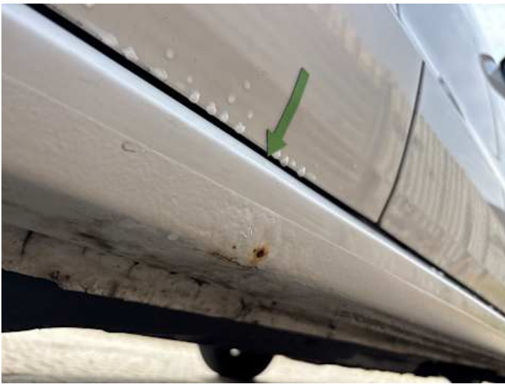
Schweller rechts (Lackschaden, Rost)
