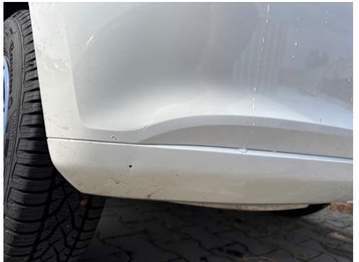
Stoßstange hinten (Kratzer, Lackschaden)
