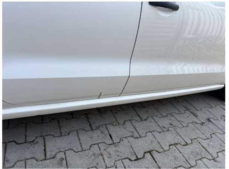
Schweller rechts (Lackschaden, Rost)
