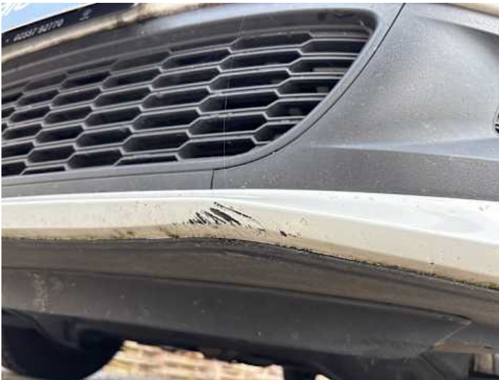
Stoßstange vorne (Kratzer, Lackschaden)
