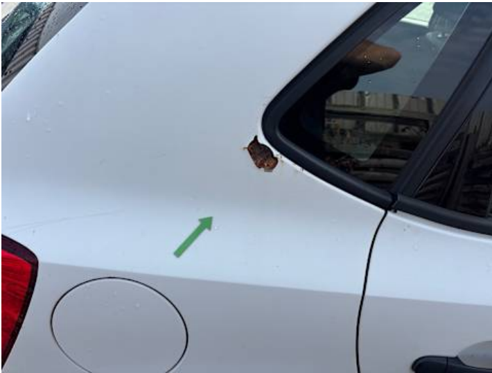
Seitenteil hinten rechts (Lackschaden, Rost)
