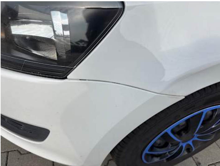
Stoßstange vorne (Spaltmaße ungenau)
