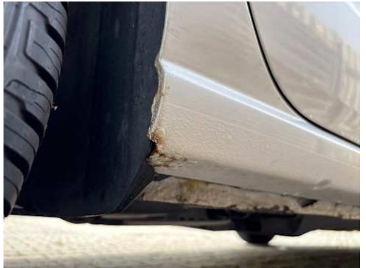
Schweller rechts (Lackschaden, Rost)
