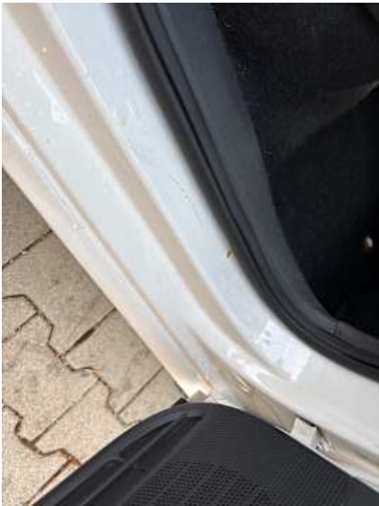
Schweller rechts (Lackschaden, Rost)
