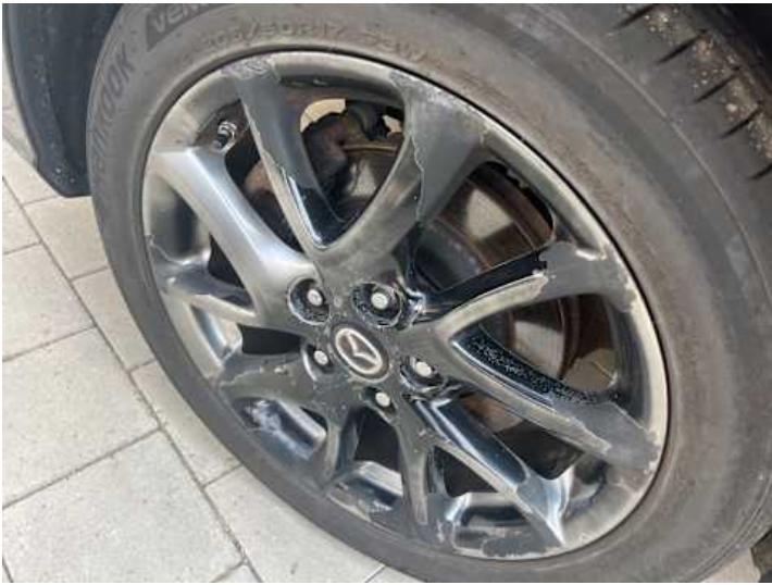
Rad (Anderer Schaden): Lackschaden
