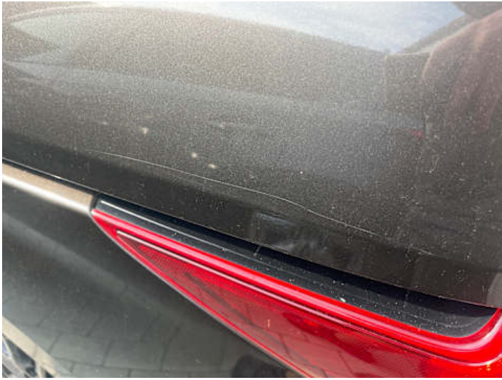
Seitenteil hinten links (Lackschaden, Kratzer)
