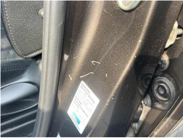
Schweller links (Lackschaden, Kratzer)
