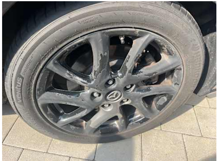
Rad (Anderer Schaden): Lackschaden
