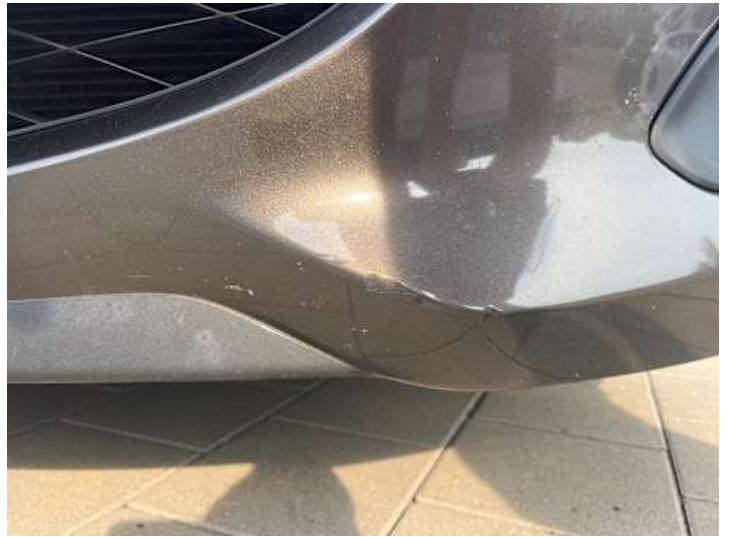
Stoßstange vorne (Lackschaden, Kratzer)
