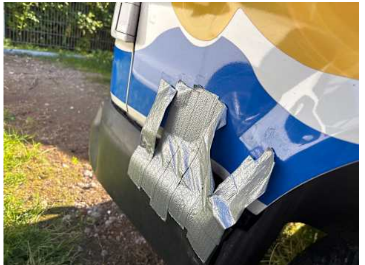
Stoßstange hinten (Riss/Bruch)
