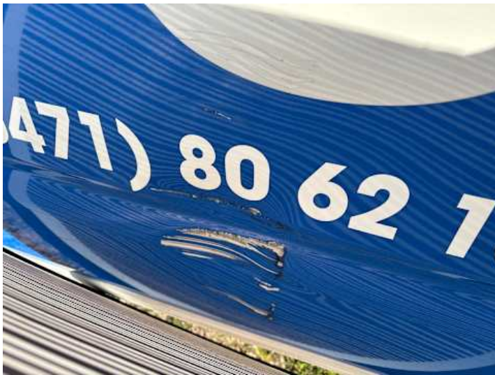
Seitenteil hinten links (Verformung)
