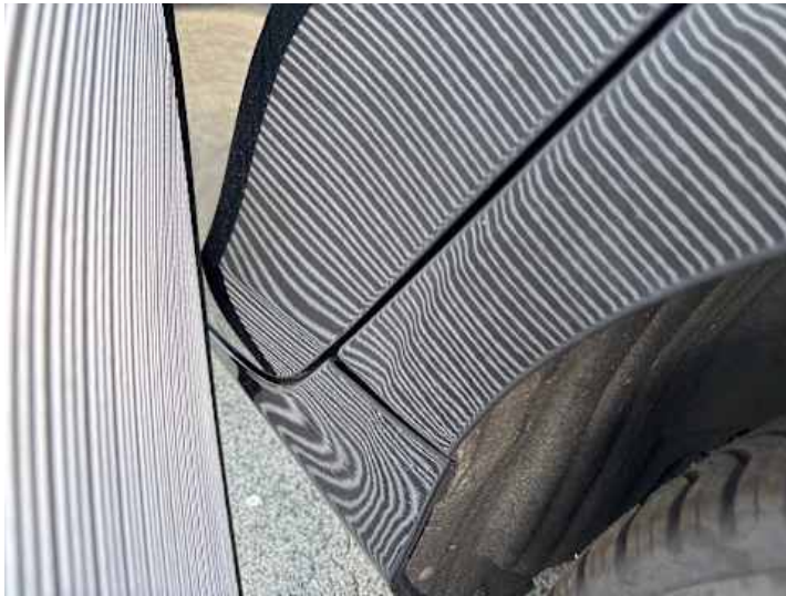
Seitenteil hinten links (Spaltmaße ungenau)
