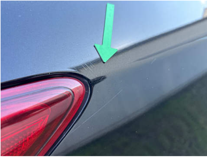
Seitenteil hinten rechts (Kratzer)
