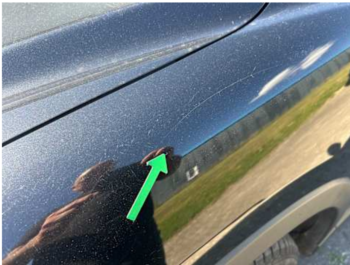
Kotflügel vorne links (Kratzer)
