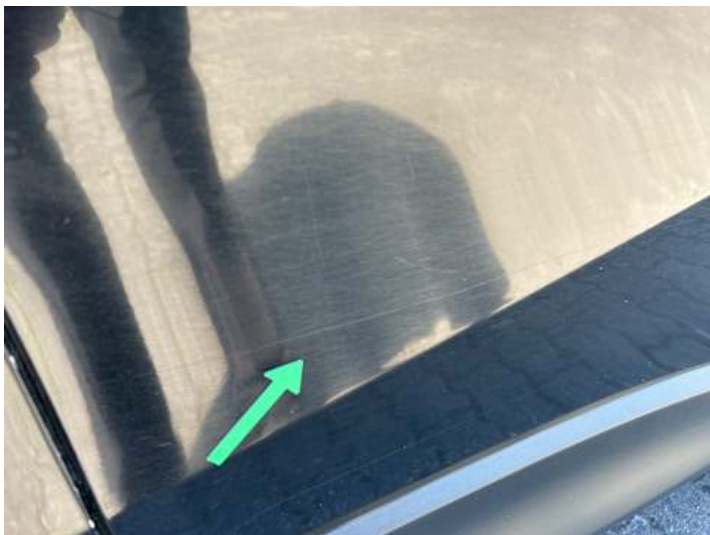
Türe hinten links (Kratzer)
