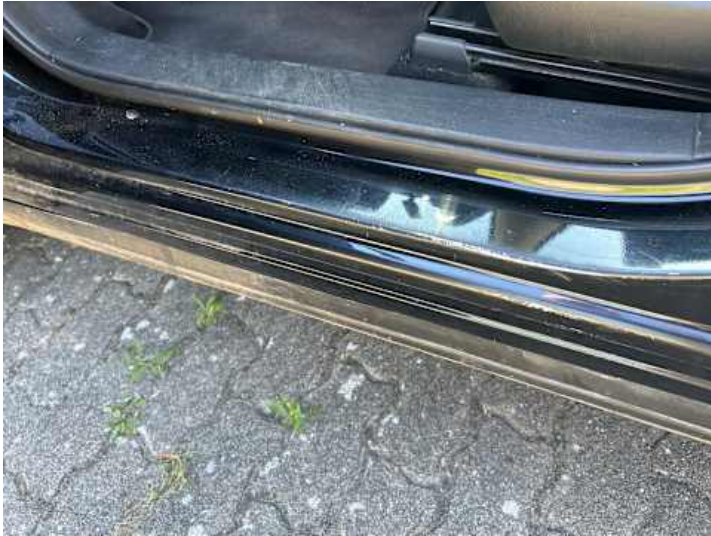
Schweller links (Kratzer)
