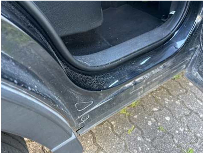
Schweller rechts (Verformung, Kratzer)
