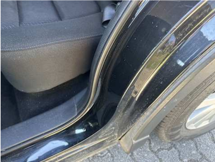
Schweller links (Kratzer)
