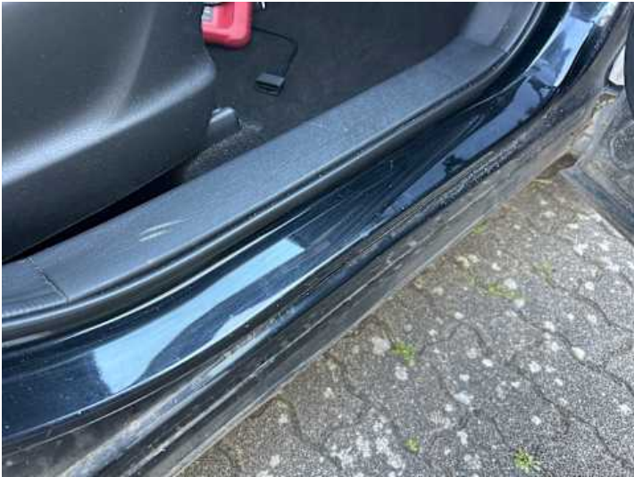
Schweller rechts (Verformung, Kratzer)
