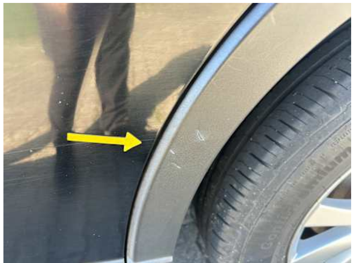
Türe hinten links (Kratzer)
