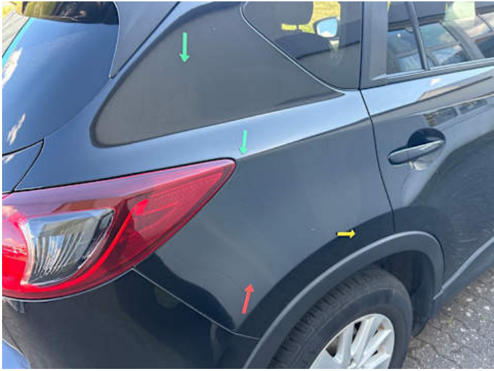
Seitenteil hinten rechts (Kratzer)
