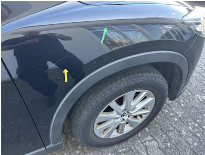
Kotflügel vorne rechts (Kratzer)
