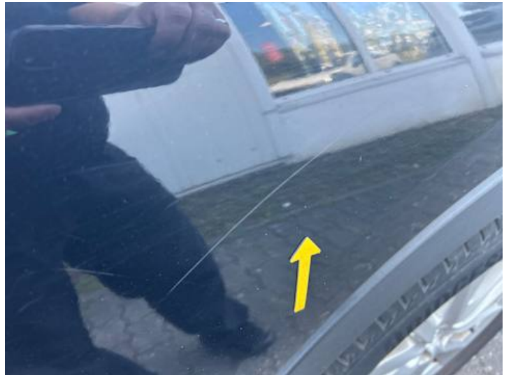
Kotflügel vorne rechts (Kratzer)
