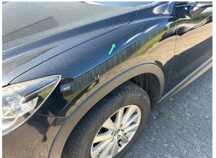
Kotflügel vorne links (Kratzer)
