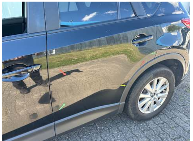
Türe hinten links (Kratzer)
