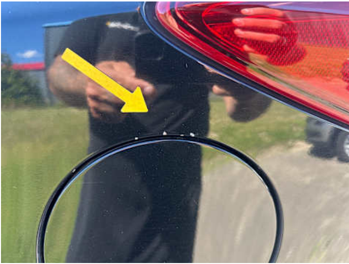
Seitenteil hinten links (Kratzer, Delle)
