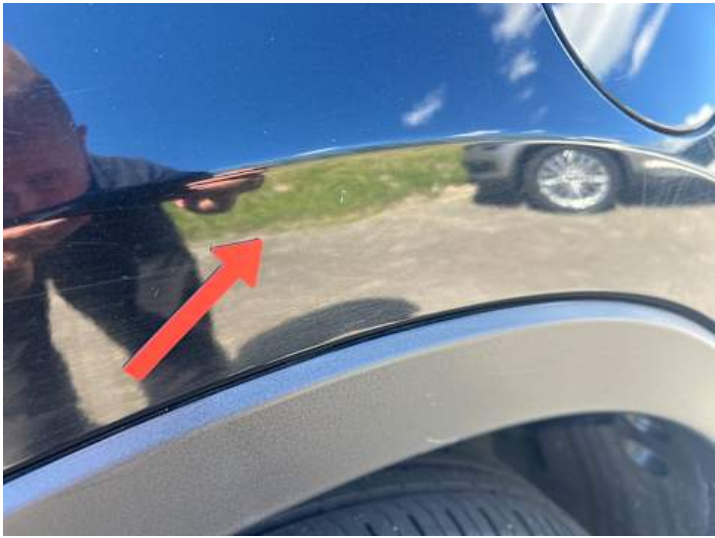
Seitenteil hinten links (Kratzer, Delle)
