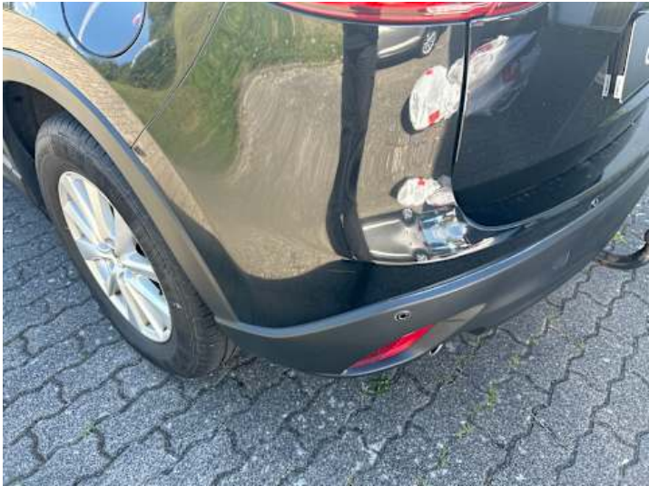
Stoßstange hinten (Lackschaden, Kratzer)
