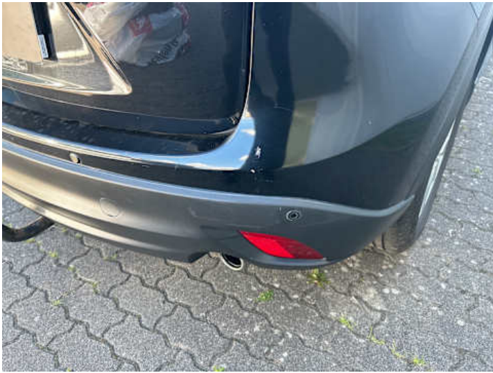
Stoßstange hinten (Lackschaden, Kratzer)
