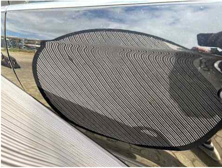
Türe hinten links (Delle)
