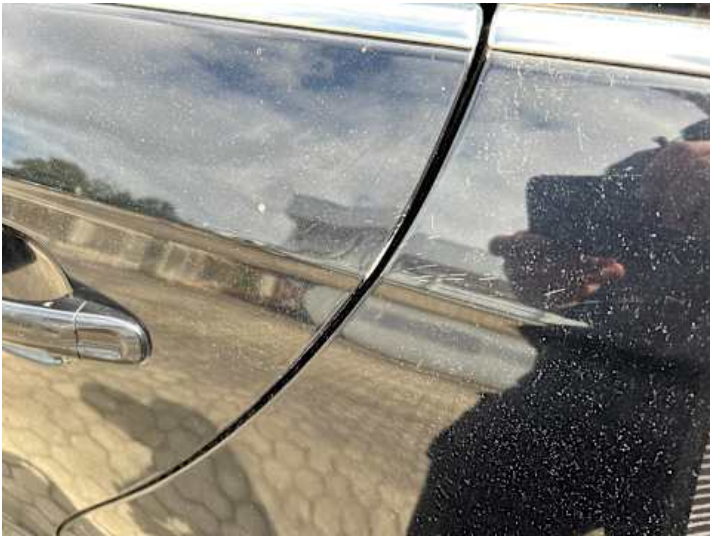
Türe hinten links (Lackschaden)
