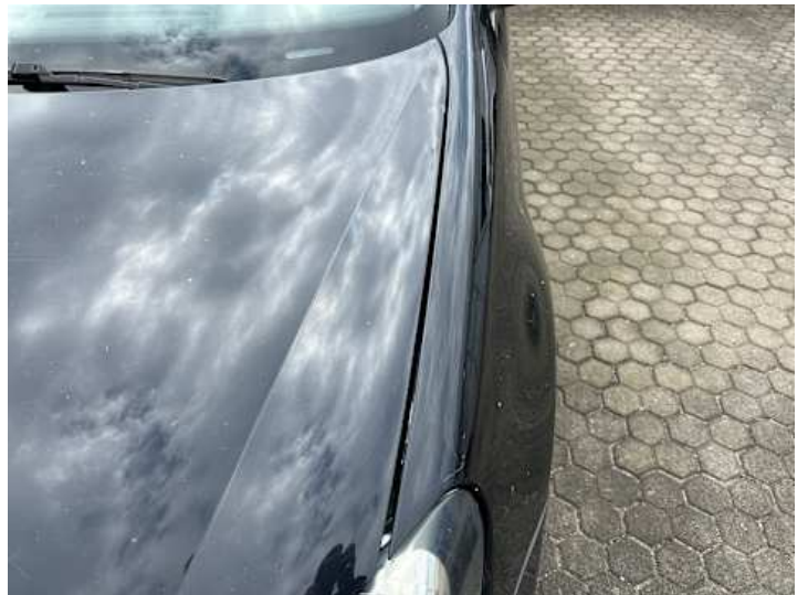
Motorhaube (Spaltmaße ungenau)
