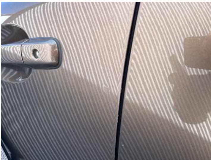
Fahrtür (Delle, Kratzer)
