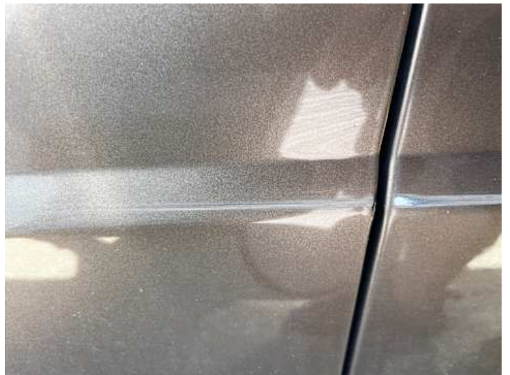
Fahrtür (Delle, Kratzer)
