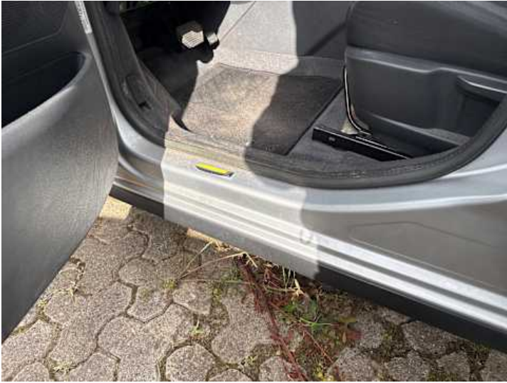
Schweller links (Delle, Kratzer)
