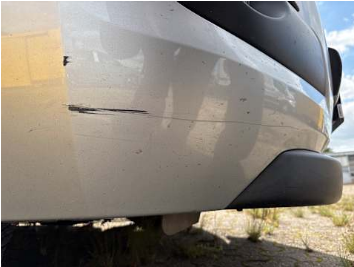
Stoßstange vorne (Lackschaden, Kratzer)
