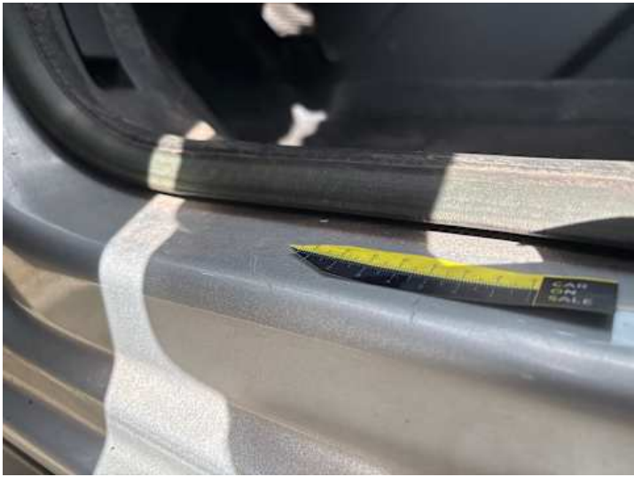
Schweller links (Delle, Kratzer)
