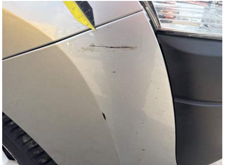
Stoßstange vorne (Lackschaden, Kratzer)
