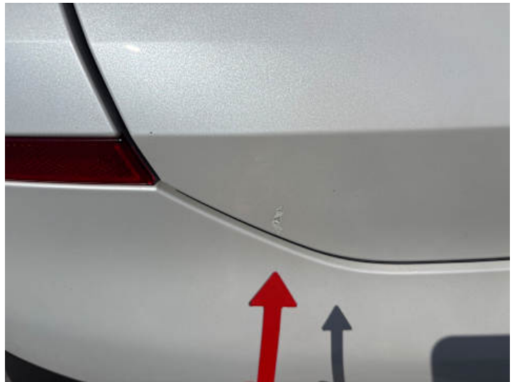
Heckklappe (Kratzer, Lackschaden)
