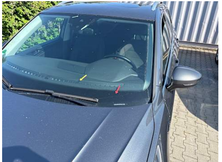
Windschutzscheibe (Kratzer, Steinschlag)
