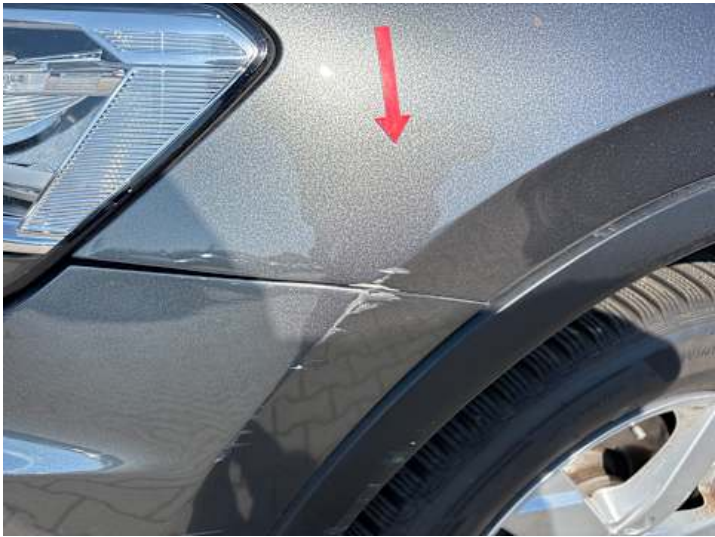
Kotflügel vorne links (Kratzer, Lackschaden)
