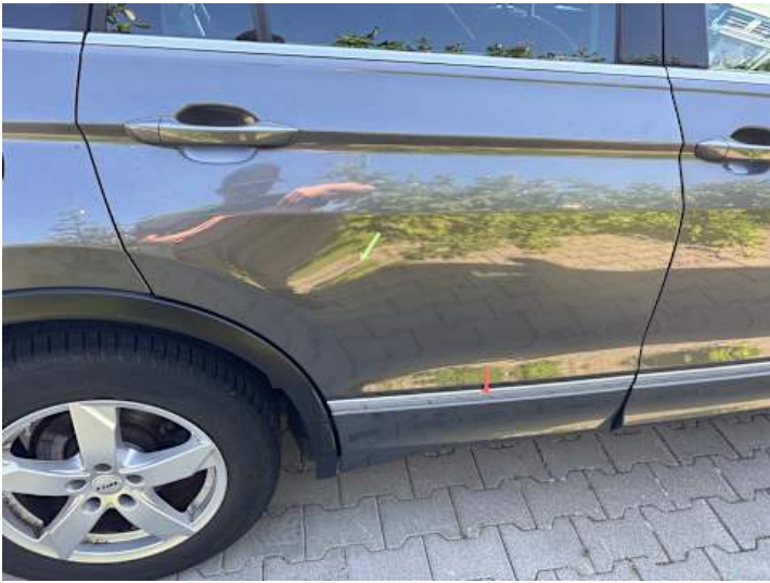
Türe hinten rechts (Kratzer, Lackschaden)
