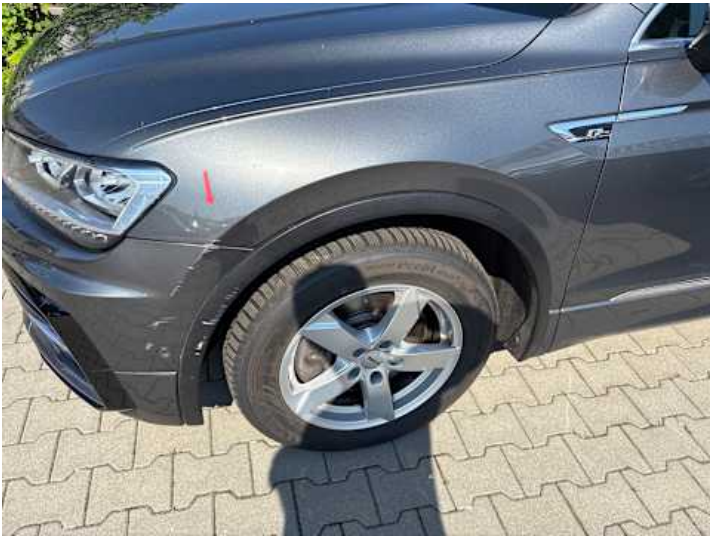
Kotflügel vorne links (Kratzer, Lackschaden)
