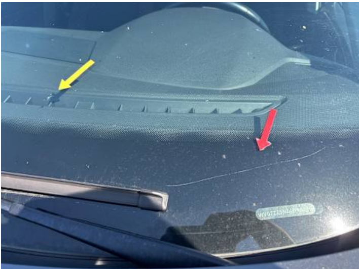
Windschutzscheibe (Kratzer, Steinschlag)
