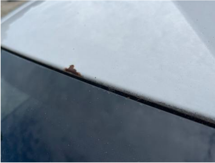
Dach (Lackschaden, Rost)
