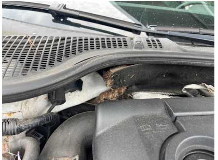
Motorhaube (Anderer Schaden): Dämmmatte beschädigt
