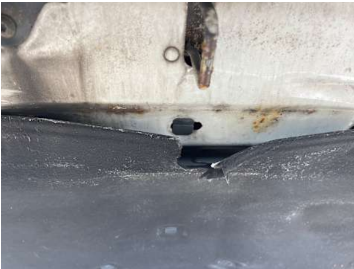
Motorhaube (Anderer Schaden): Dämmmatte beschädigt
