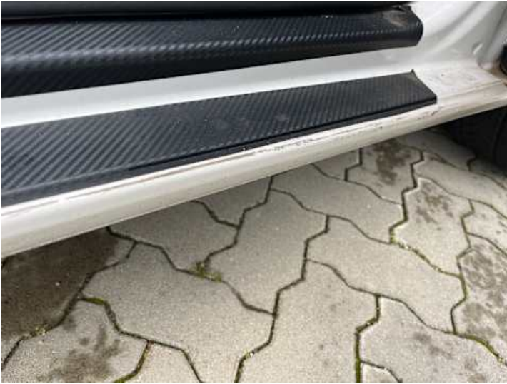
Schweller rechts (Kratzer, Lackschaden)
