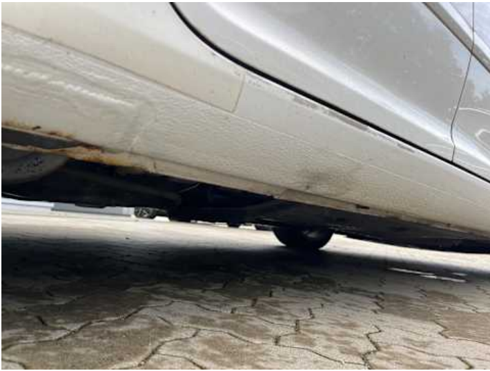
Schweller rechts (Verformung)
