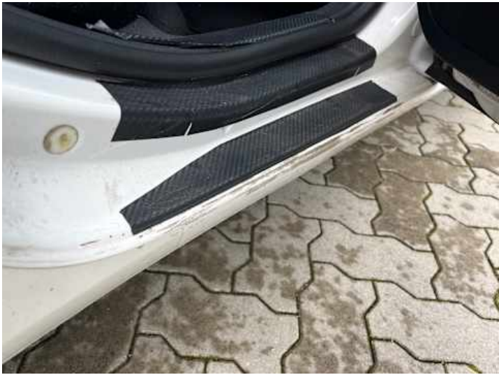
Schweller rechts (Kratzer, Lackschaden)
