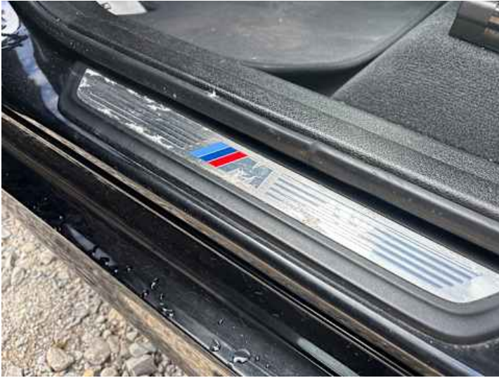
Schweller links (Anderer Schaden): Verschleiß
