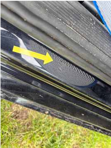
Schweller rechts (Delle, Kratzer)
