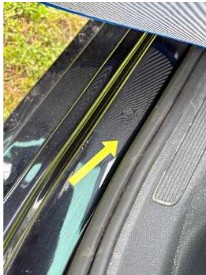
Schweller links (Delle)
