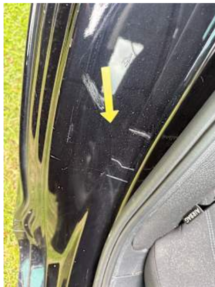
Schweller rechts (Delle, Kratzer)
