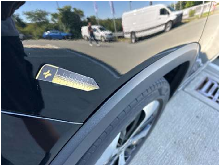
Seitenteil hinten rechts (Spaltmaße ungenau)
