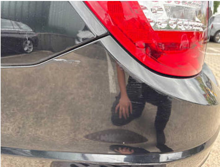
Stoßstange hinten (Lackschaden, Kratzer, Riss/Bruch)
