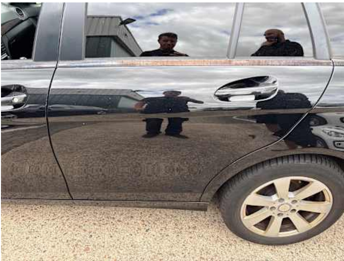
Türe hinten links (Lackschaden, Delle)
