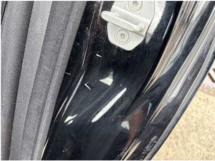
Seitenteil hinten links (Lackschaden, Delle)
