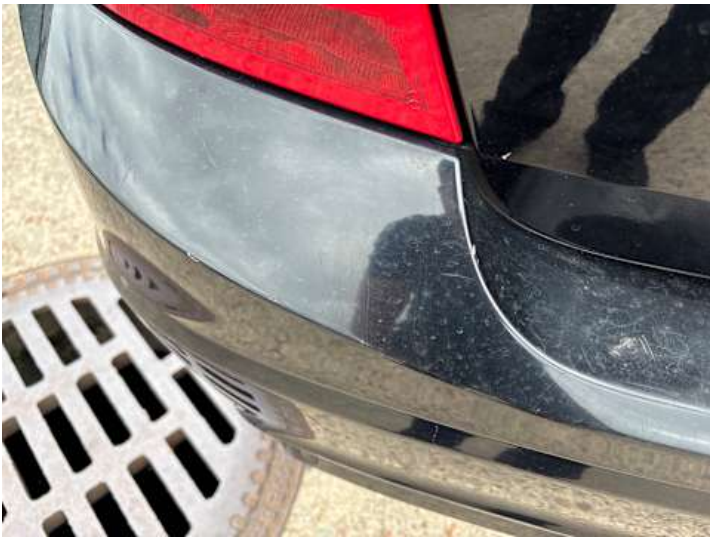
Stoßstange hinten (Lackschaden, Kratzer, Riss/Bruch)
