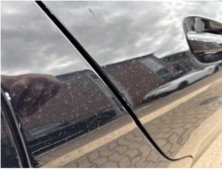
Türe hinten rechts (Kratzer, Delle, Lackschaden)
