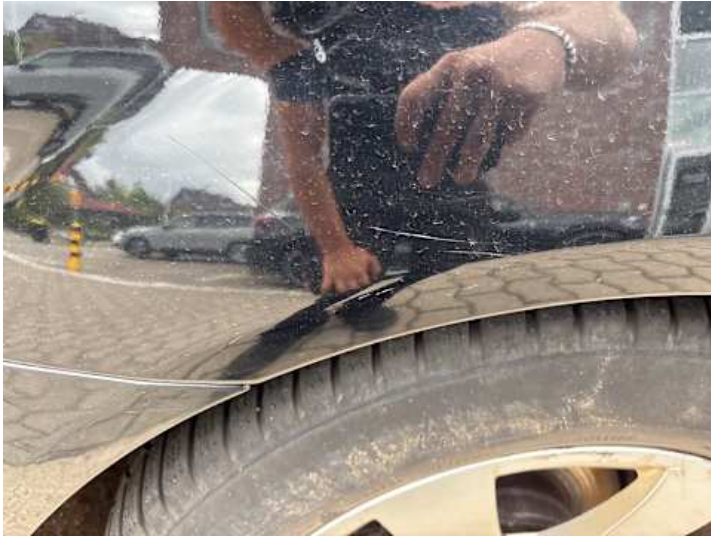
Seitenteil hinten rechts (Delle, Kratzer, Lackschaden)
