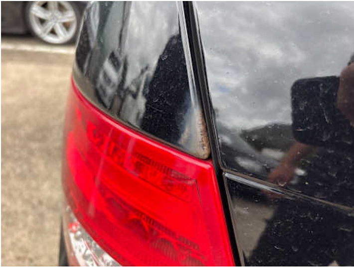
Seitenteil hinten links (Rost, Delle, Kratzer)
