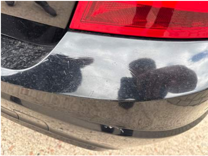
Stoßstange hinten (Lackschaden, Kratzer, Riss/Bruch)
