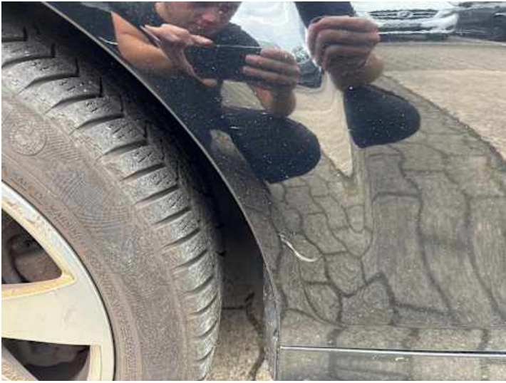
Kotflügel vorne links (Lackschaden, Kratzer)
