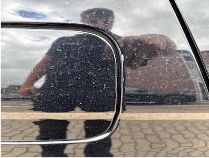
Seitenteil hinten rechts (Delle, Kratzer, Lackschaden)
