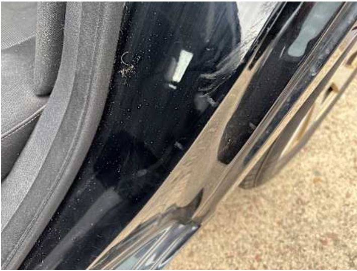
Seitenteil hinten links (Lackschaden, Delle)
