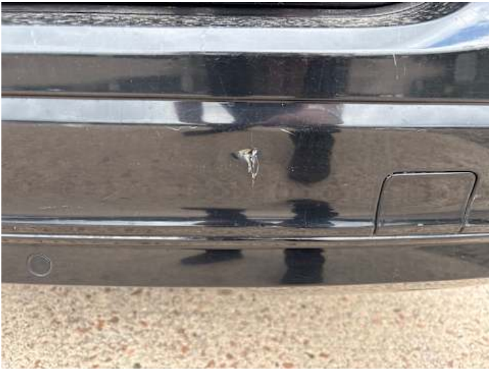
Stoßstange hinten (Lackschaden, Kratzer, Riss/Bruch)
