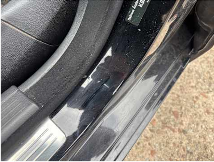
Schweller links (Lackschaden)
