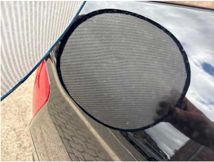
Seitenteil hinten rechts (Delle, Kratzer, Lackschaden)
