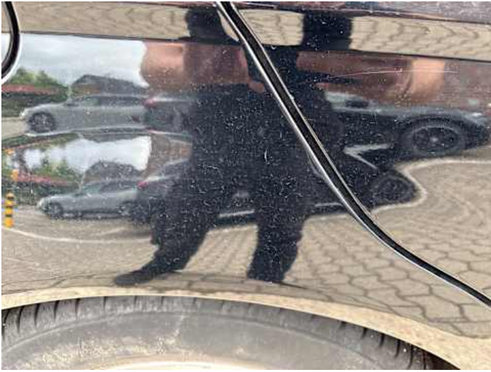
Seitenteil hinten rechts (Delle, Kratzer, Lackschaden)
