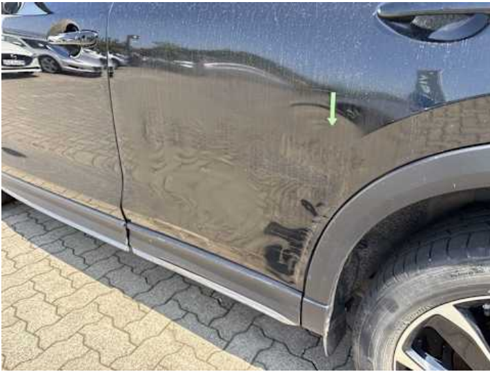
Türe hinten links (Kratzer, Verformung)
