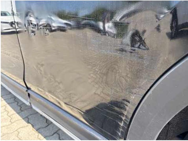
Türe hinten links (Kratzer, Verformung)
