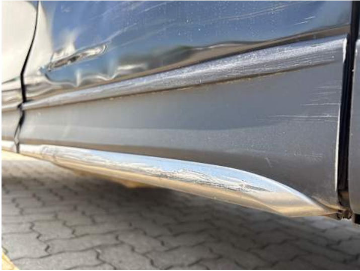
Türe hinten links (Kratzer, Verformung)
