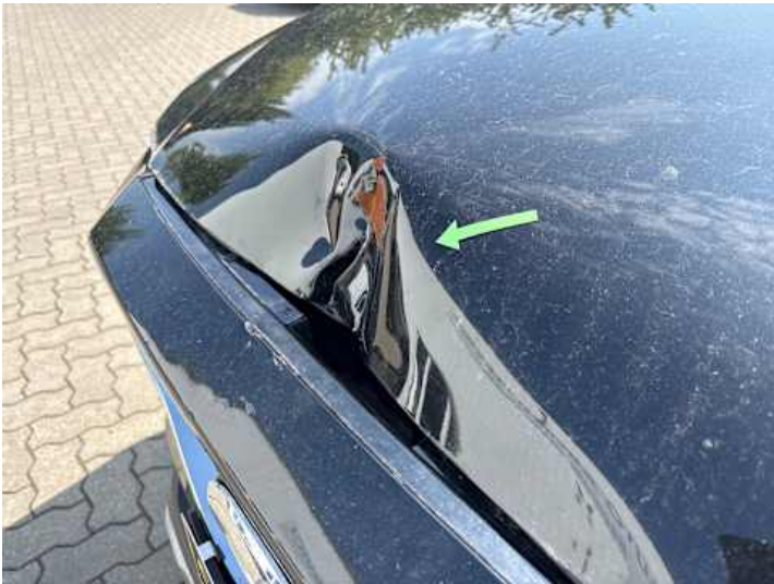
Motorhaube (Verformung, Kratzer, Rost)
