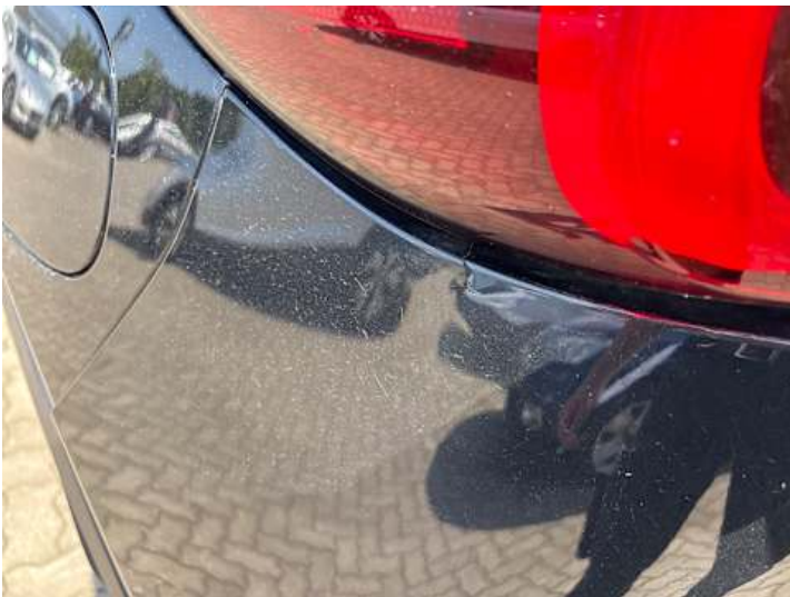
Stoßstange hinten (Riss/Bruch)
