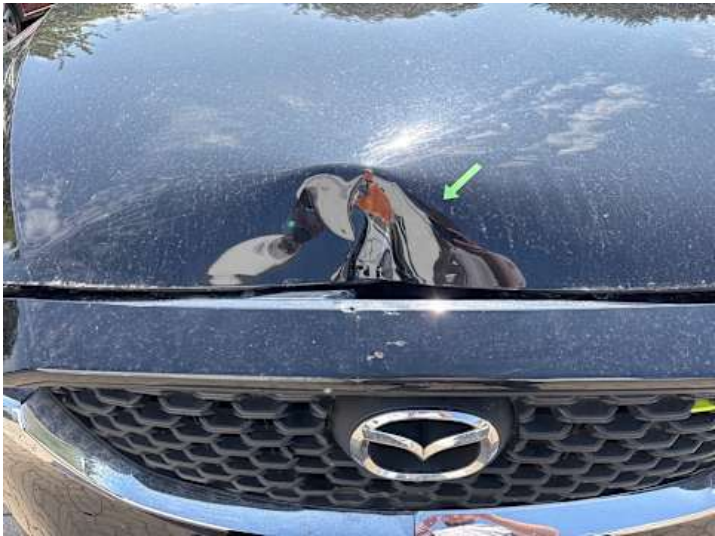
Motorhaube (Verformung, Kratzer, Rost)
