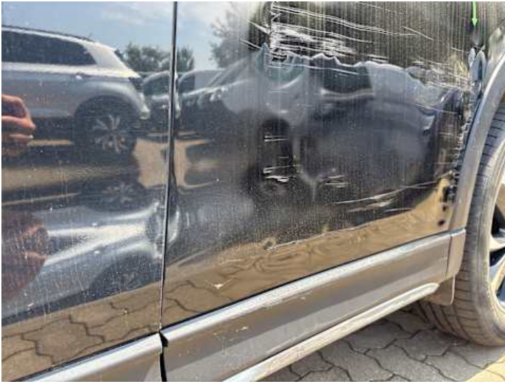
Türe hinten links (Kratzer, Verformung)
