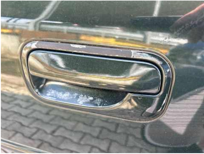
Türe hinten links (Lackschaden)
